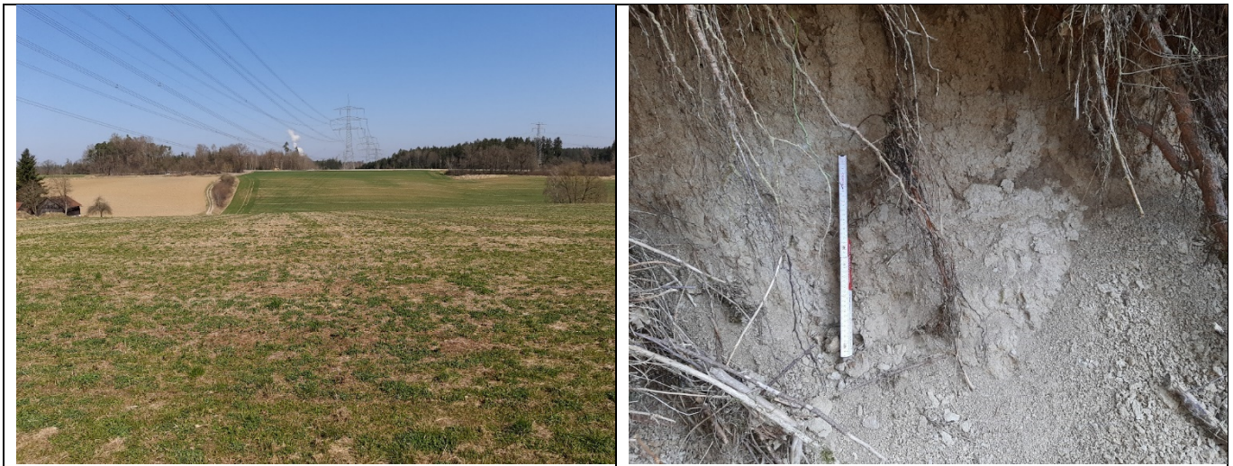
Abbildung 4: links: Schlechte Aufschlussverhältnisse und eingeschränkte Zugänglichkeit entlang der Trasse; rechts: Hanganschnitt eines Gerinnes als guter Aufschluss
