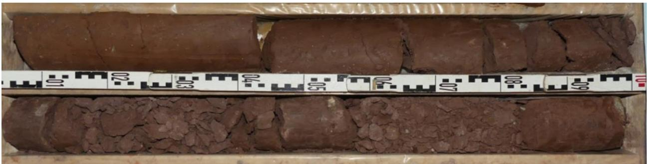
Abbildung 3: typischer Bohrkern des Feuerletten
