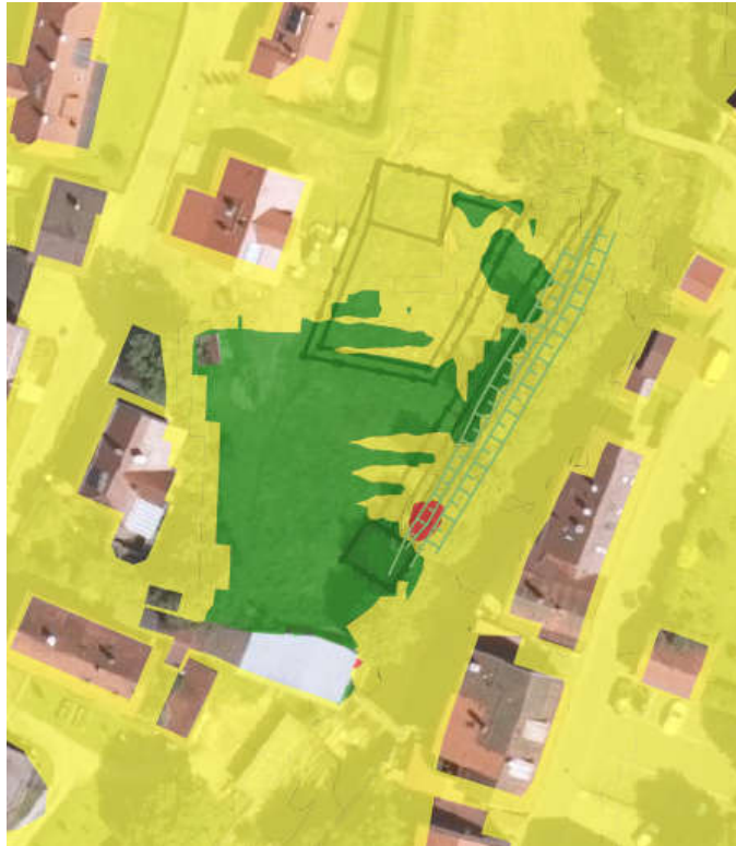
HQ100-Wassertiefenvergleich Plan – Ist (Bereich Kraftwerk)
