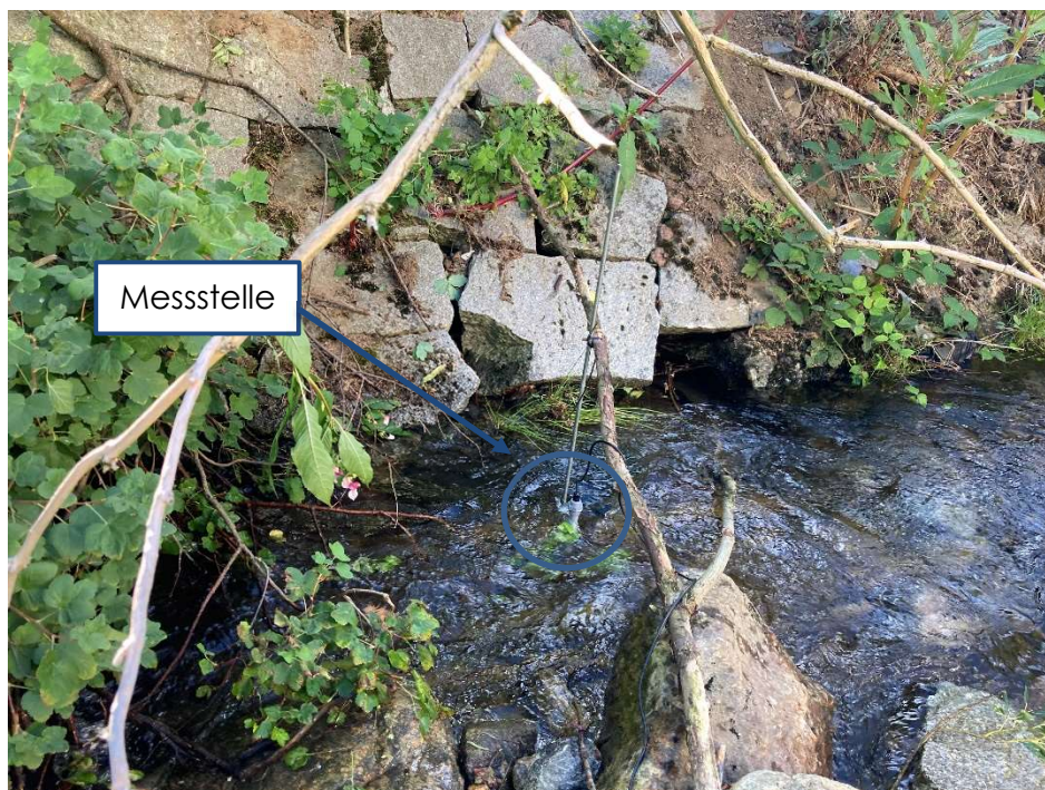
Abbildung 3: Messstelle zur Erfassung des Verlaufs der Leitfähigkeit (Foto: IB Pfeffer)
