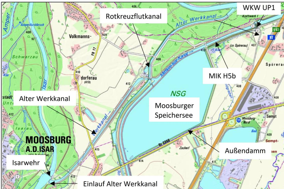
Abbildung 1: Lageplan mit Kennzeichnung der betroffenen Kanalanlagen im Planungsgebiet 1 /18/
