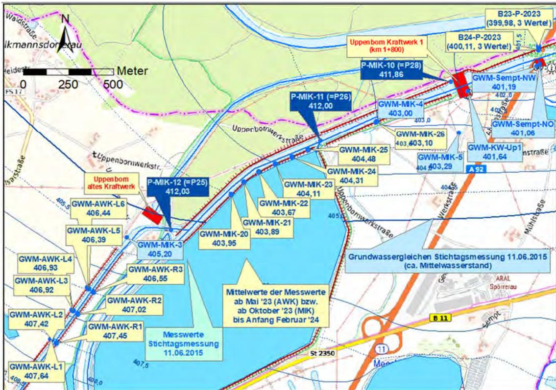
Abbildung 14: Grundwassergleichen ca. MW (Stichtagsmessung 11.06.2015) und Messwerte MW (neue Messstellen, aktuell vorliegende Messzeiträume, westlicher Teilbereich)
