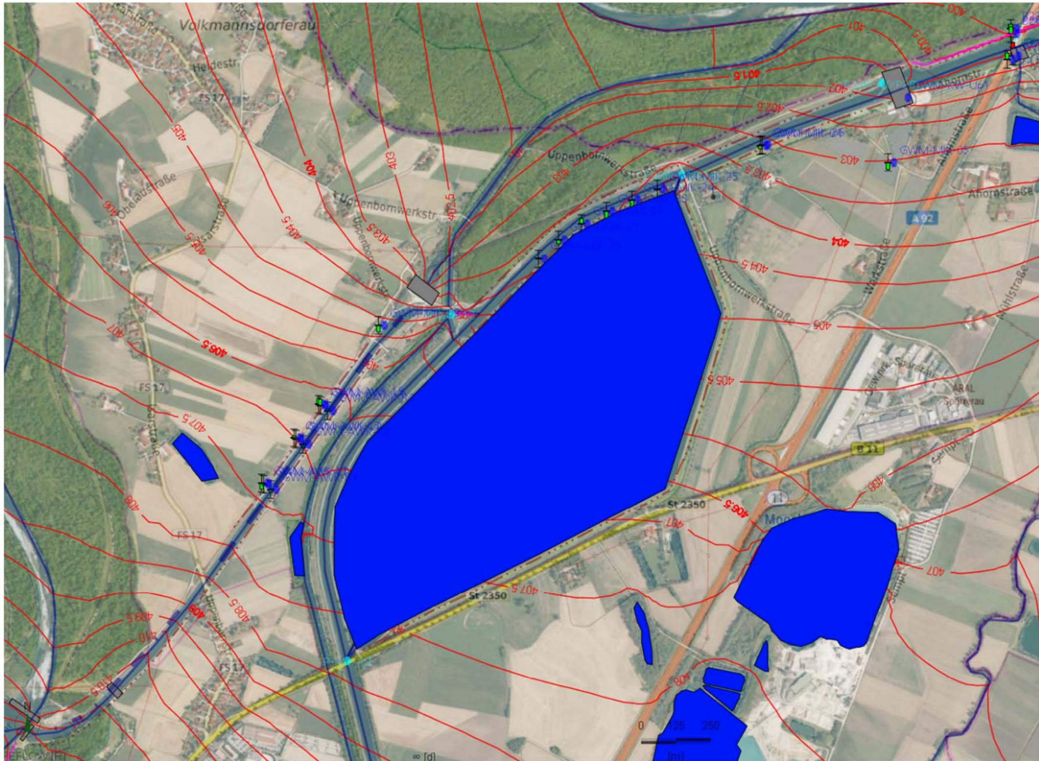
Abbildung 29, Seite 34 Erläuterungsbericht: Ergebnis Kalibrierung Ist-Zustand – Grundwassergleichen Bereich West
