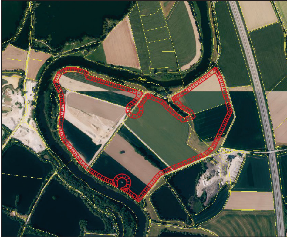
Abbildung 5: Orthofoto der geplanten Abbaufäche mit eingezeichneten Böschungen an den Abbaugrenzen
