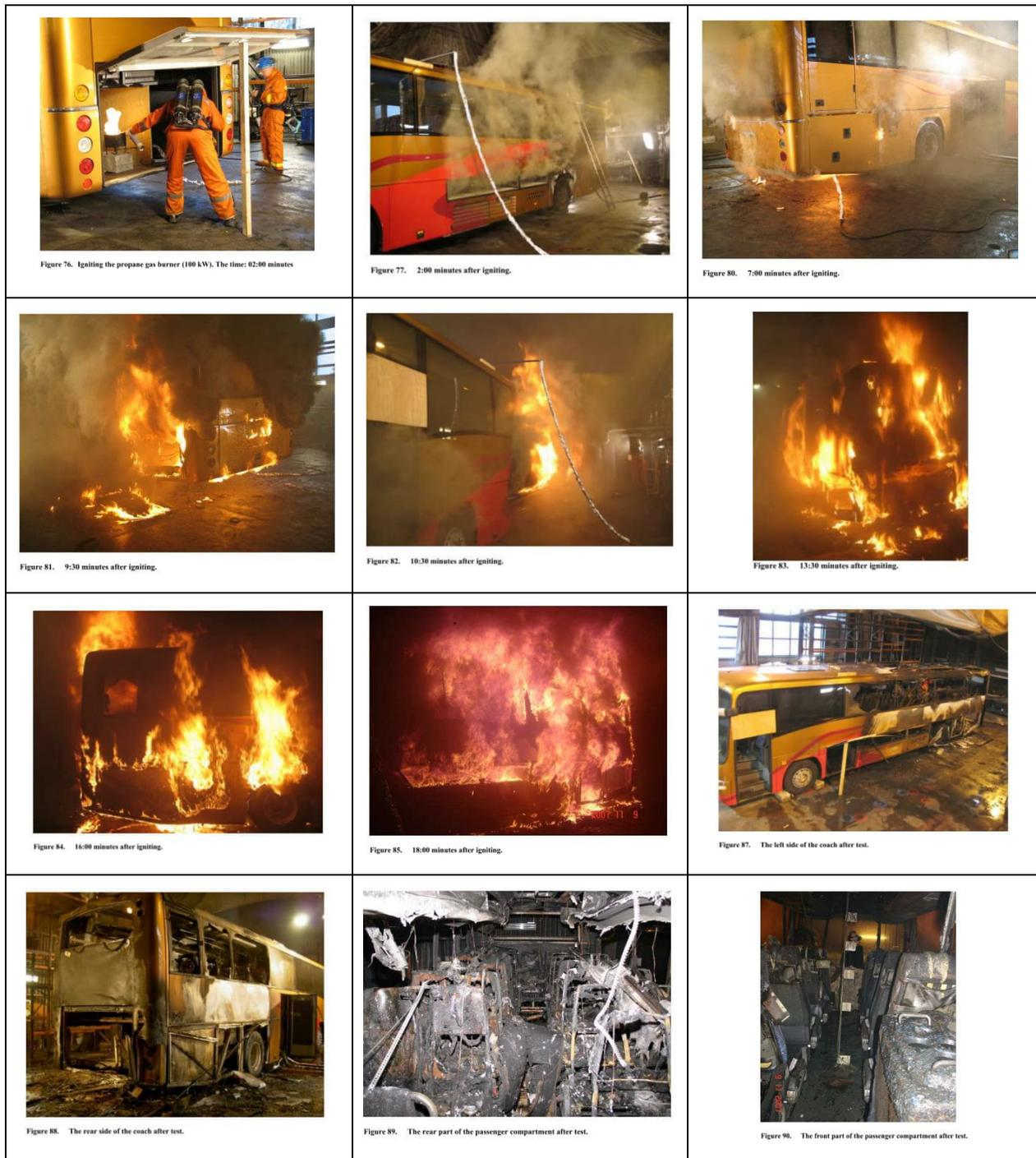
**Abbildung 2** Aufnahmen zum zeitlichen Verlauf eines Brandversuchs mit Reisebus
