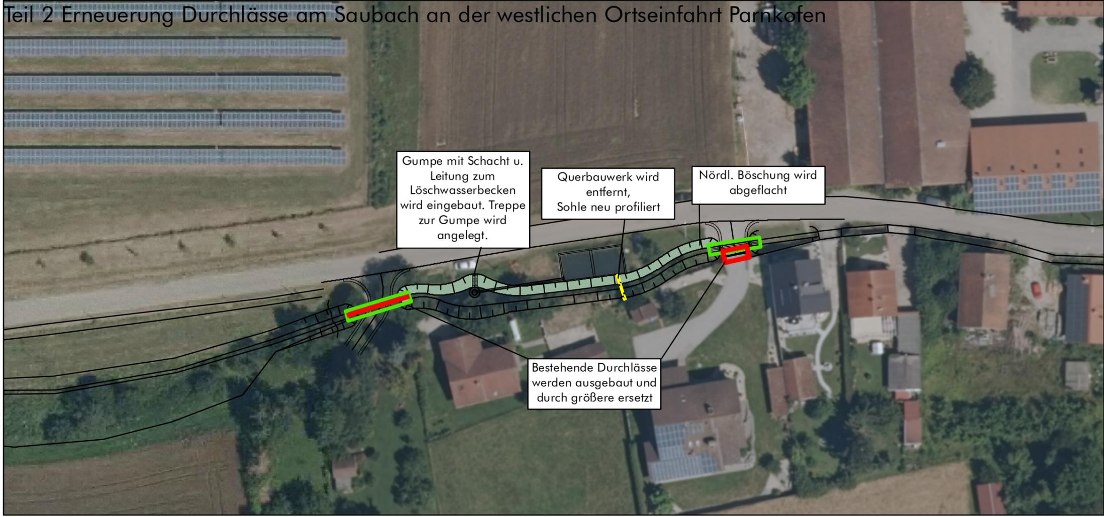
Gumpe mit Schacht u. Leitung zum Löschwasserbecken wird eingebaut. Treppe zur Gumpe wird angelegt.
