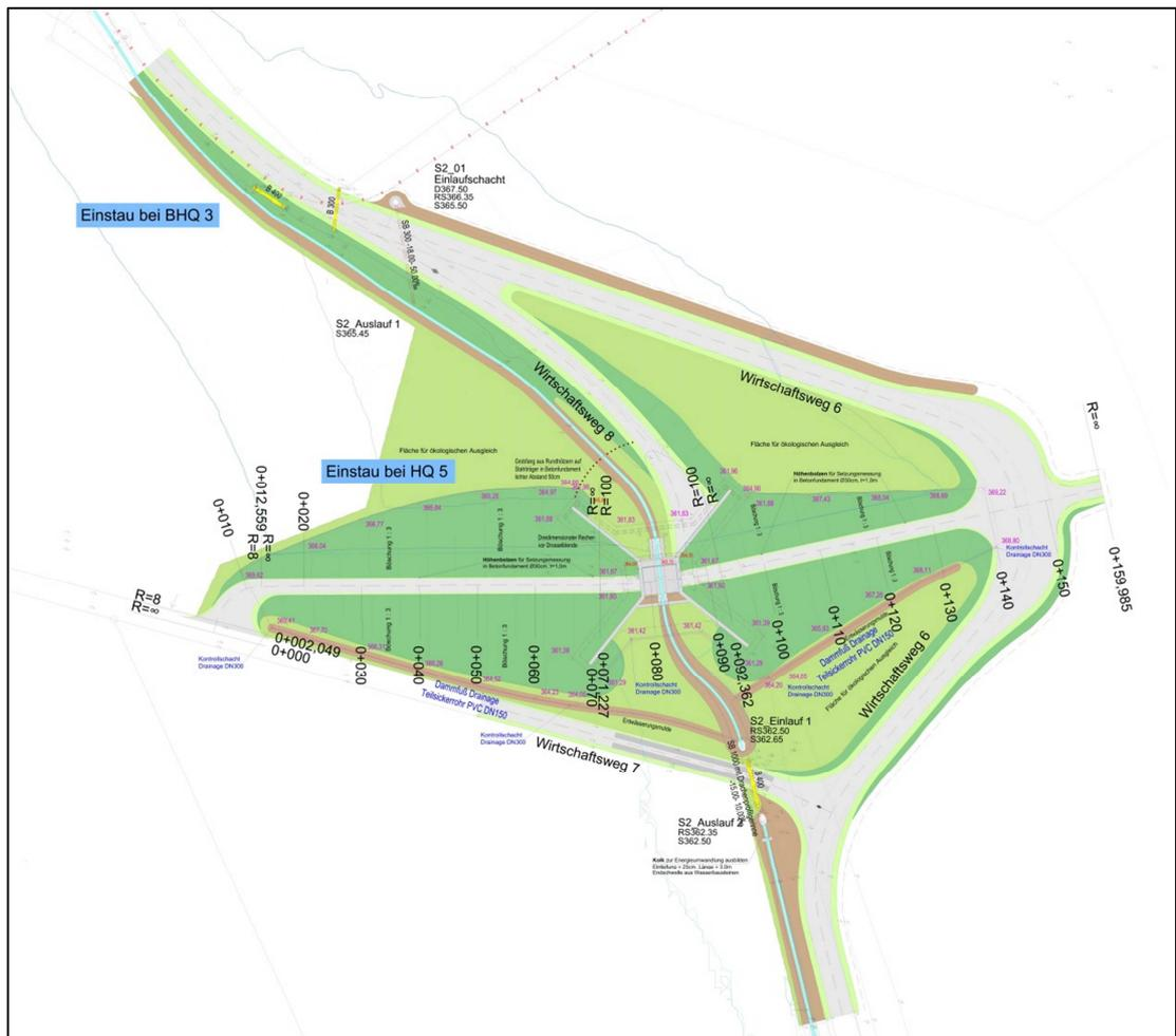
Abbildung 7 Geplante Maßnahme HRB S2 am Entwässerungsgraben ohne Namen - Lageplan
