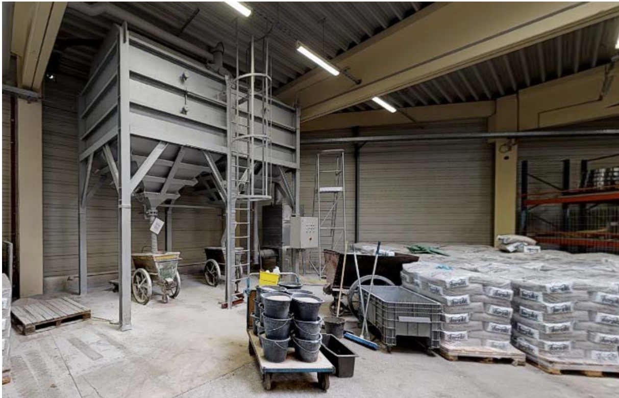
Abbildung 27: 3D-Scan Abstellhalle Sandsilo / Sandlager, Eimer für manuelle Besandung
