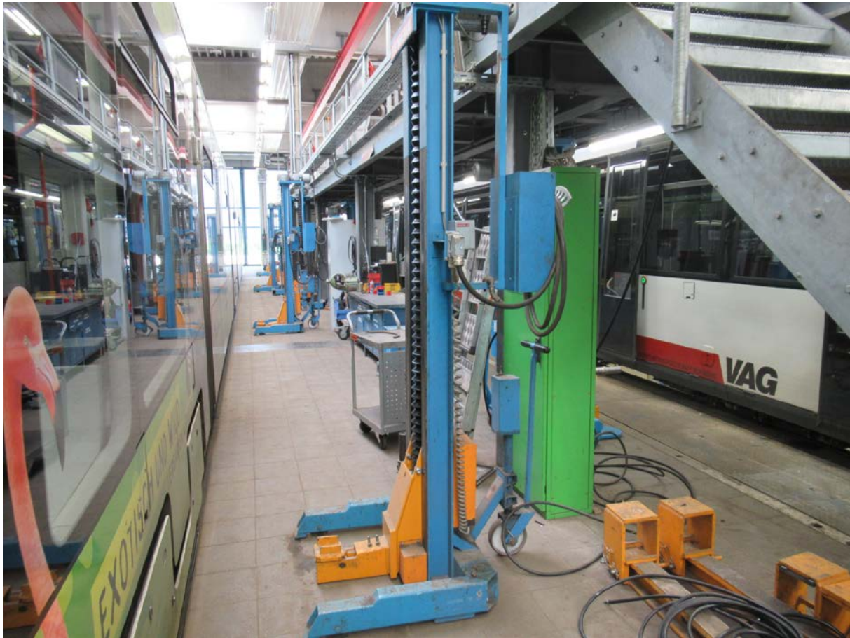
Abbildung 17: Hebeböcke Bestand 6 t
