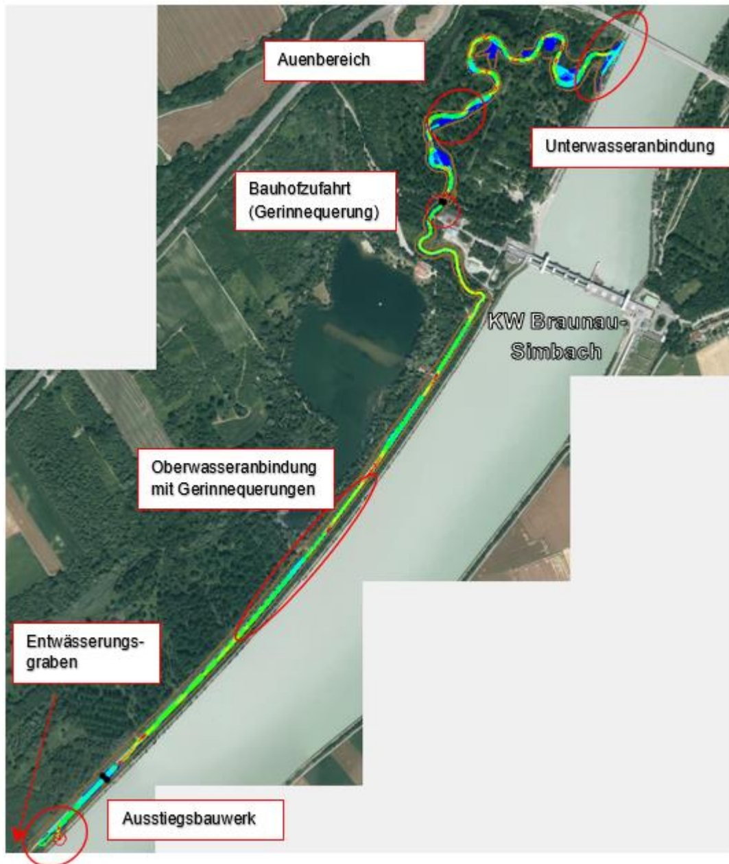
Abbildung 5: Überblick über das Vorhaben (Abbildung aus Technischem Erläuterungsbericht (Anlage 02.01), Büro Werner Consult)
