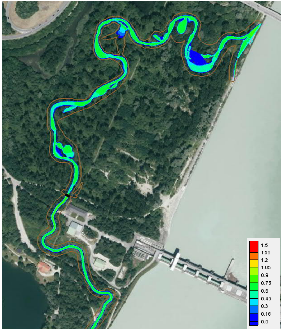
Abbildung 11: Fließtiefen bei Q = 4 \text{ m}^3/\text{s}
