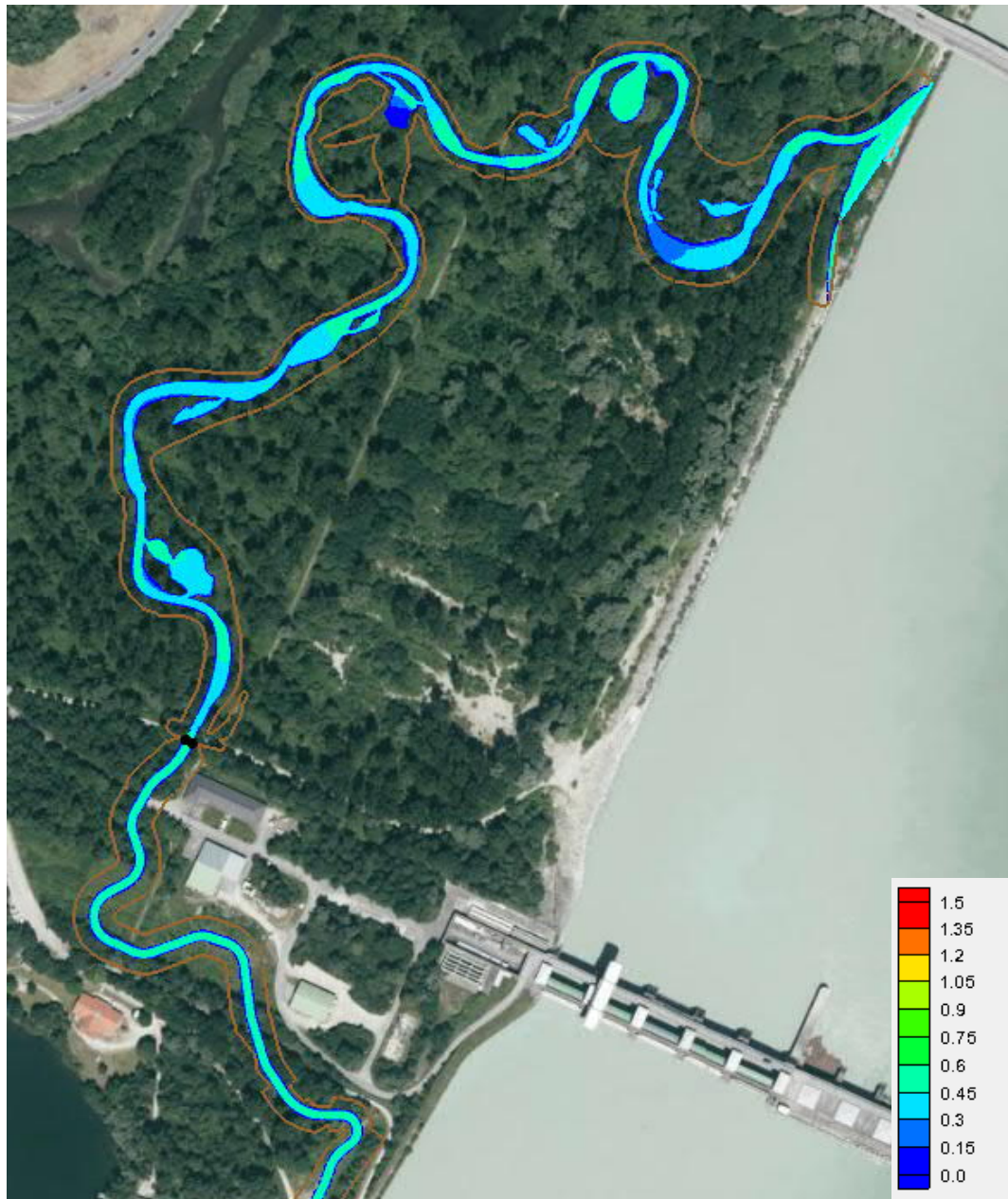
Abbildung 10: Fließtiefen bei Q = 2 \text{ m}^3/\text{s}
