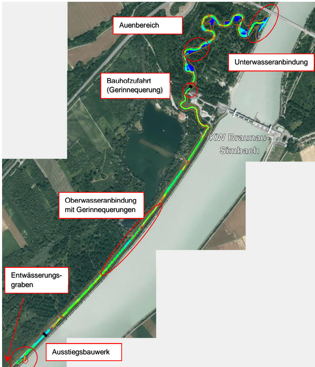
Abbildung 2: Linienführung des Umgebungsgewässers am Innkraftwerk Braunau-Simbach
