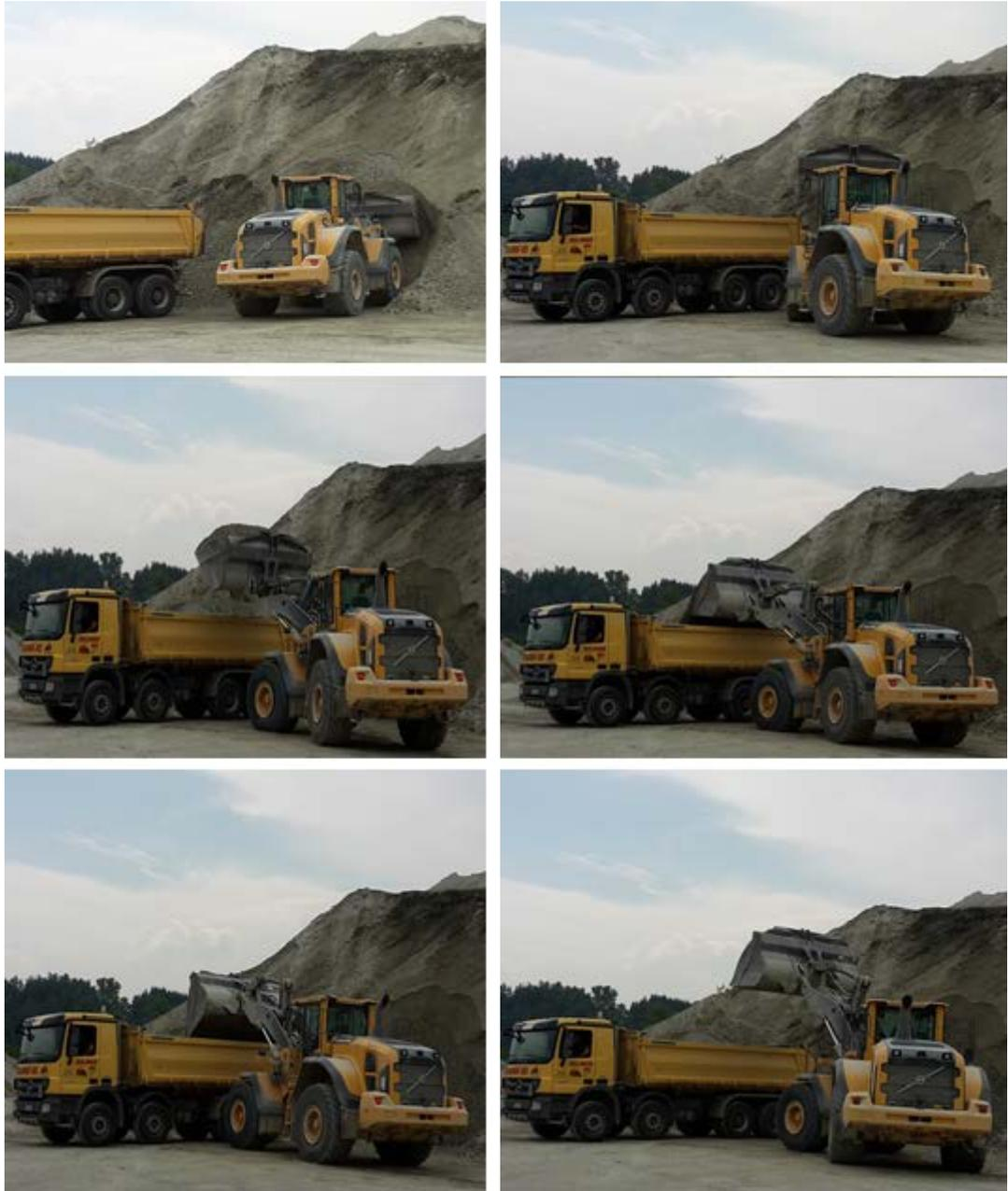
Abbildung 6. Beladung eines Lkw mit dem Radlader.
