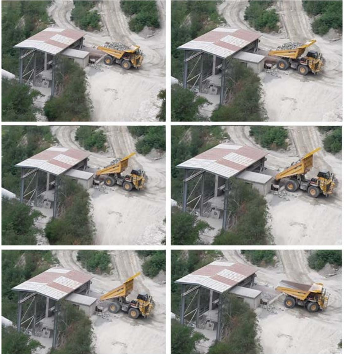
Abbildung 5. Abkippen von gesprengtem Granit vom Skw in den Vorbrecher.
