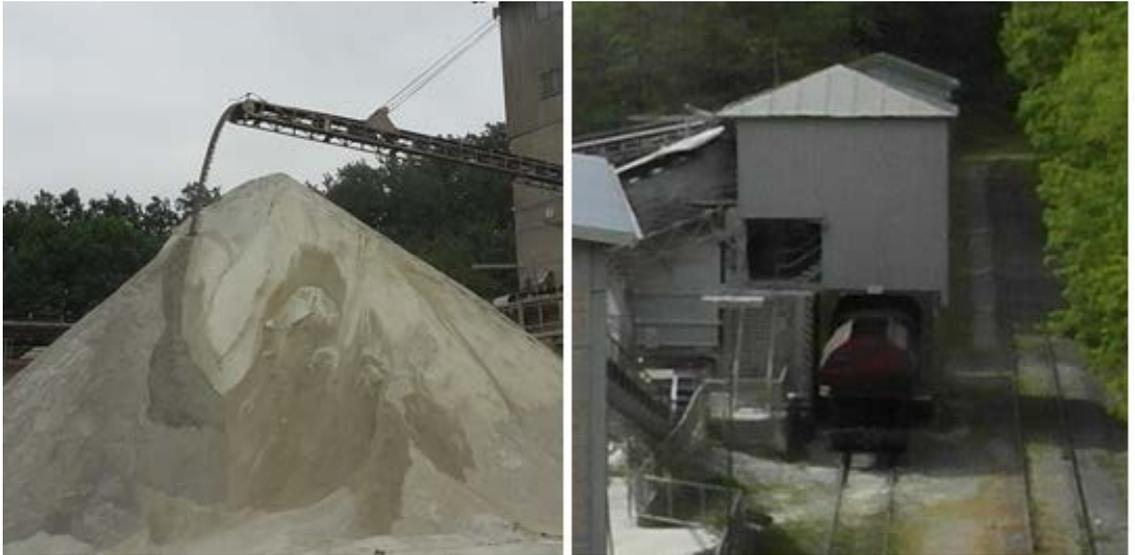
Abbildung 7. Abwurf von Fließband auf Halde (links) und Darstellung Abwurfstelle von Förderband in Bahnwagen inkl. Einhausung (rechts).
