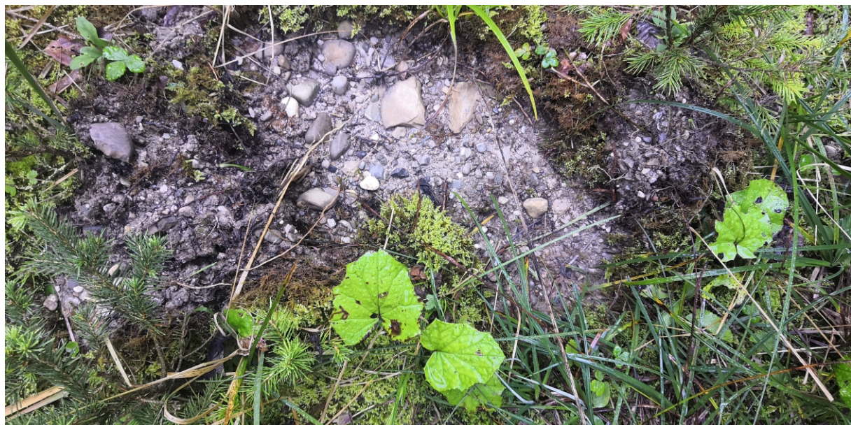
Foto 2: Anstehender natürlicher Kiesboden im Sohlbereich
