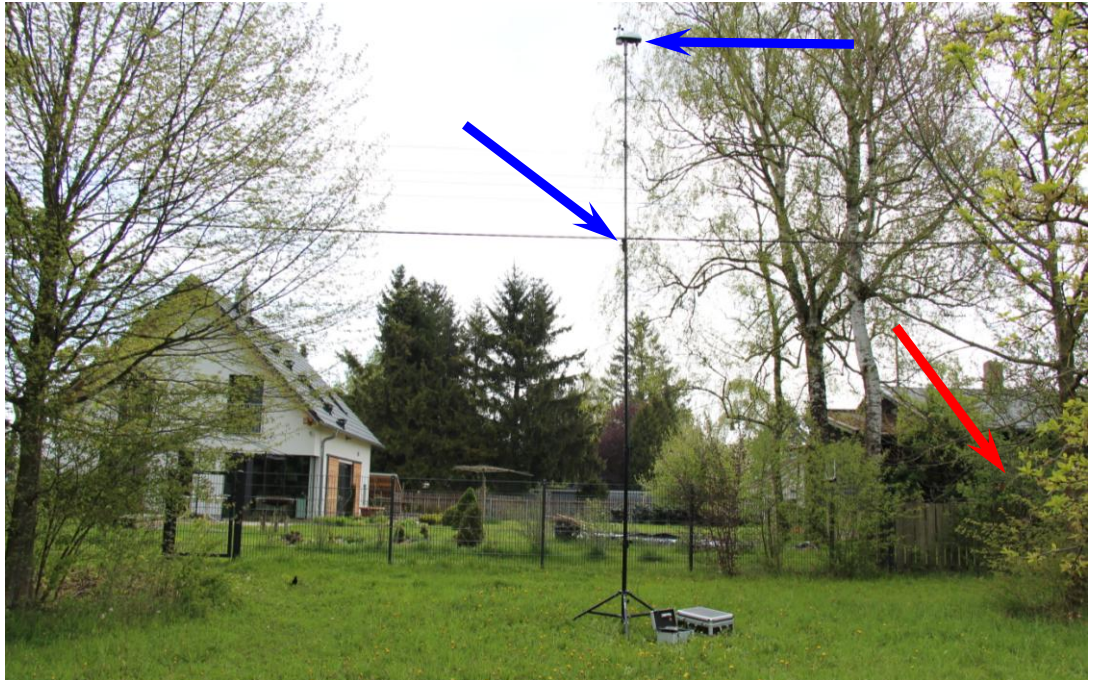
Foto 17: Blick in Richtung Osten auf das Wohngebäude IO 4 „Storchenweg 22“ (roter Pfeil), das sich im B-Plan-Gebiet Nr. 1871 „Hackersiedlung“ in einem „Reinen Wohngebiet“ befindet. Der Standort des Messmikrofons in h = 4 m Höhe über Gelände ebenso gekennzeichnet (unterer blauer Pfeil) wie der Standort der Wettermessstation der Fa. Davis am oberen Ende des Stativs.
