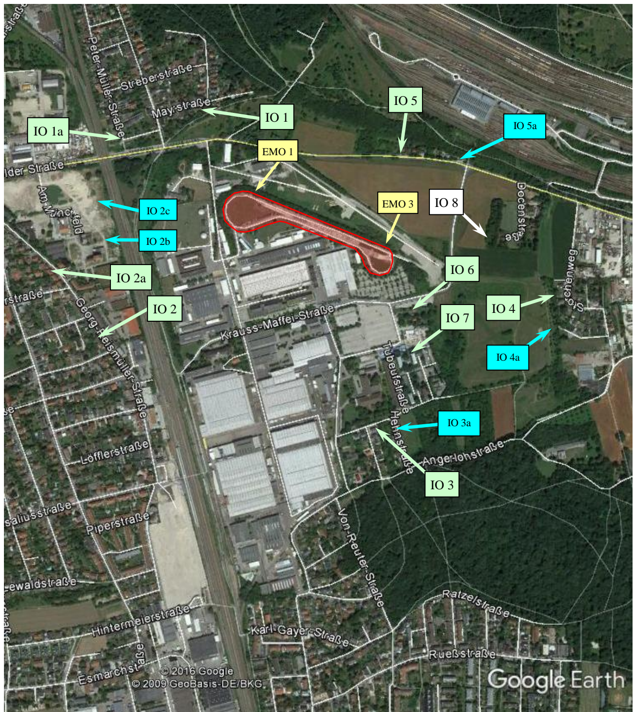
Detailliertes Luftbild mit dem Anlagengelände der Fa. Krauss-Maffei Wegmann GmbH & Co. KG am Standort „Krauss-Maffei-Straße 11“ in 80997 München, mit der Panzerteststrecke, mit den maßgeblichen Immissionsorten IO 1 bis IO 5a sowie mit den zusätzlichen Immissionsorten IO 6 bis IO 8 in der Nachbarschaft sowie mit den Emissionsmesspunkten EMO 1 und EMO 3
