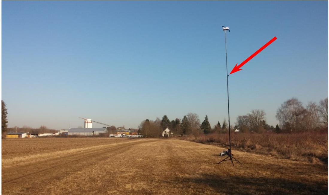
Foto 9: Blick in ost-südöstliche Richtung auf den Messpunkt MP 3 (Pfeil) in  $s = 235$  m Abstand vom Rand der Panzerteststrecke und in  $h = 4$  m Höhe über Gelände (etwa 75 m östlich von der Zufahrt zum Anlagengelände und in Richtung zum IO 4 „Storchenweg 22“). Am oberen Ende des Stativs ist die Wettermessstation zu erkennen.
