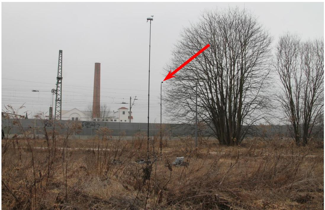
Foto 8: Blick in westnordwestliche Richtung auf den Messpunkt MP 2 (Pfeil) in  $s = 220$  m Abstand vom Rand der Panzerteststrecke und in  $h = 4$  m Höhe über Gelände (etwa 10 m östlich vom Radweg - auf der Ostseite der Eisenbahnstrecke). Am oberen Ende eines zweiten (vorgelagertem) Stativ ist die Wettermessstation zu erkennen.
