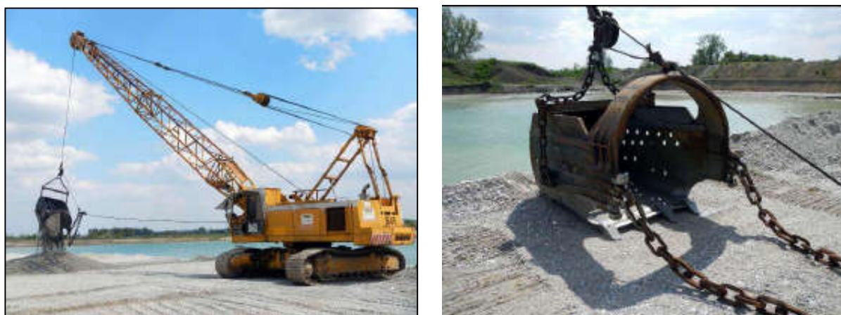
Abbildung 10: Seilbagger während des Betriebs (links) bzw. Schürfkübel (rechts) (a)
