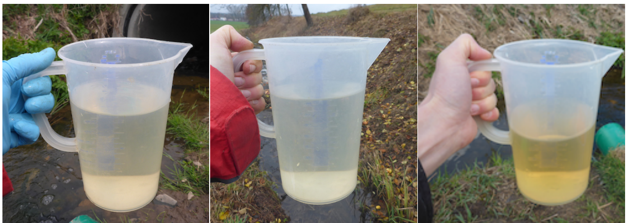
Abb. 37: Auffällig schwach gefärbtes Abwasser der ARA in Mai und November 2021 sowie typisch gefärbtes Abwasser im April 2021. Links: Probenwasser vom 04.05.2021. Mitte: Probenwasser vom 17.11.2021. Rechts: Probenwasser vom 13.04.2021.
