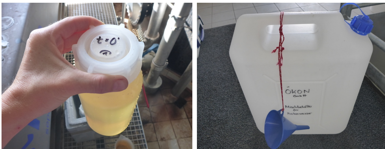
Abb. 10: Probenahme qualifizierter Stichproben bei den Versuchen zur Fällmittelreduktion. Links: Startprobe des fällmittelreduzierten Abwassers der ARA zu Beginn der zweistündigen Beprobung bei Versuch Nr. 1 bei 60% des Fällmitteleinsatzes. Rechts: Mischbehälter zur Sammlung der Einzelproben.
