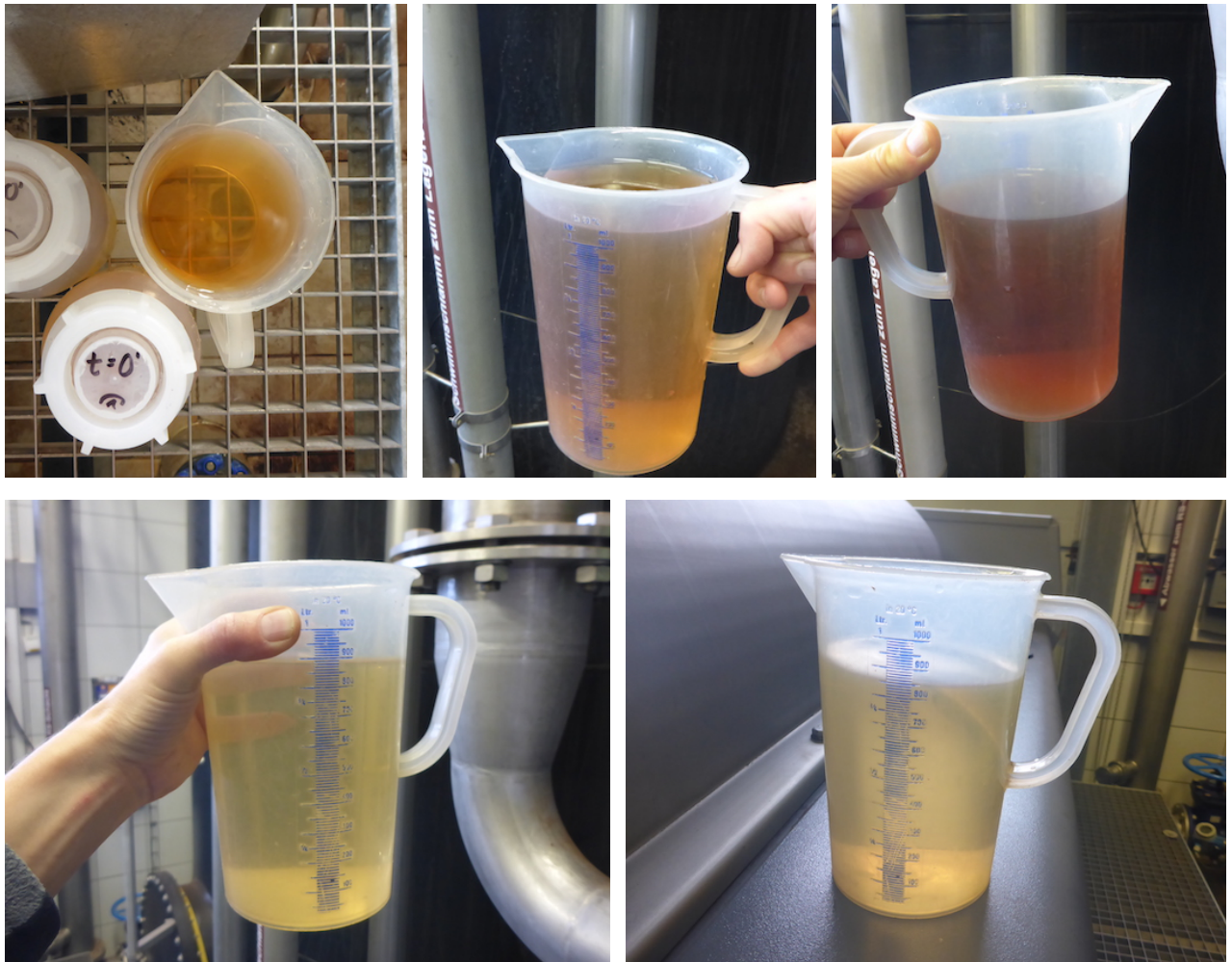
Abb. 38: Abwasser der Betriebskläranlage im fällmittelreduzierten Zustand und im anschließenden Normalbetrieb einige Tage nach dem Versuchsdurchlauf. Obere Reihe: Abwasser bei einer reduzierten Fällmittelzugabe mit 60 % Fällmitteleinsatz im Juni 2021 (linkes Bild) und bei je 49 % Fällmitteleinsatz im Oktober 2021 (mittleres Bild) und Februar 2022 (rechtes Bild). Zu erkennen ist, dass bei der Fällmittelreduktion im Februar 2022 eine besonders tiefe Braunfärbung entstand. Untere Reihe: Abwasser aus der wieder im Normalbetrieb laufenden Anlage nach dem Fällmittelreduktionsversuch im Oktober 2021 (linkes Bild) und im Februar 2022 (rechtes Bild). Das Abwasser weist wieder die übliche gelblich-bräunliche Färbung auf.
