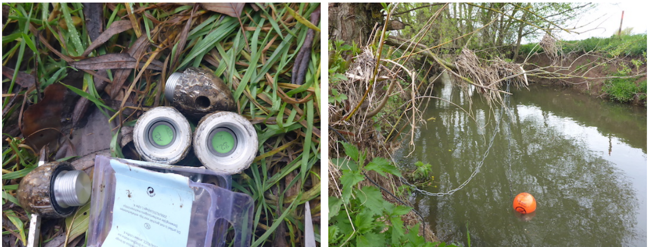
Abb. 9: Temperaturlogger, eingesetzt in aufgeschraubte Metallkapsel, und Verankerung der eingekapselten Logger an einer am Ufer festgeketteten Schwimmboje im Strom der Kleinen Weisach.
