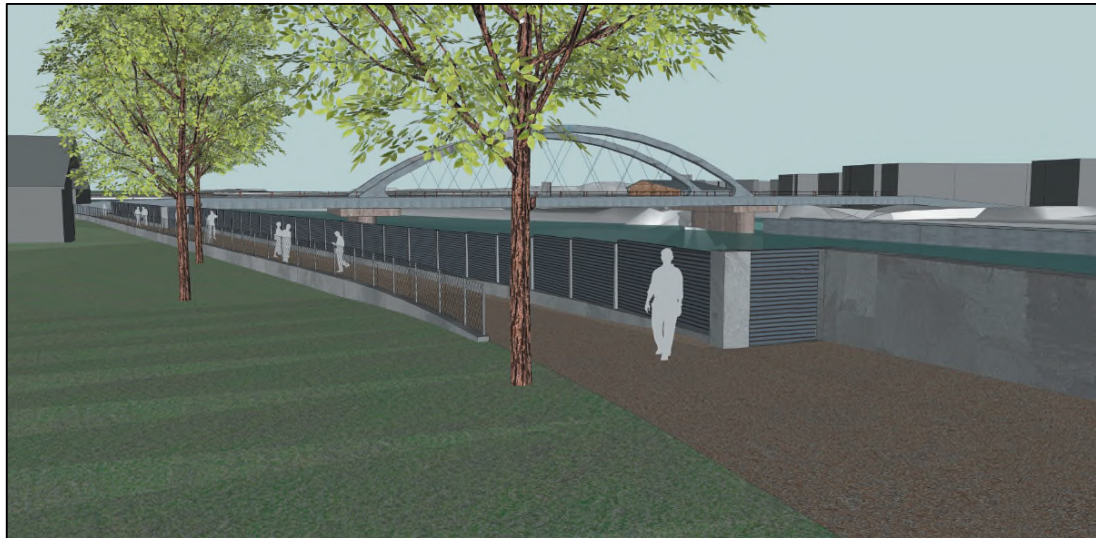
Abbildung 7: HWS-Mauer Variante 2 – Tiefliegender Uferweg mit Dammbalkensystem (geschlossen, Ansicht von Osten).
