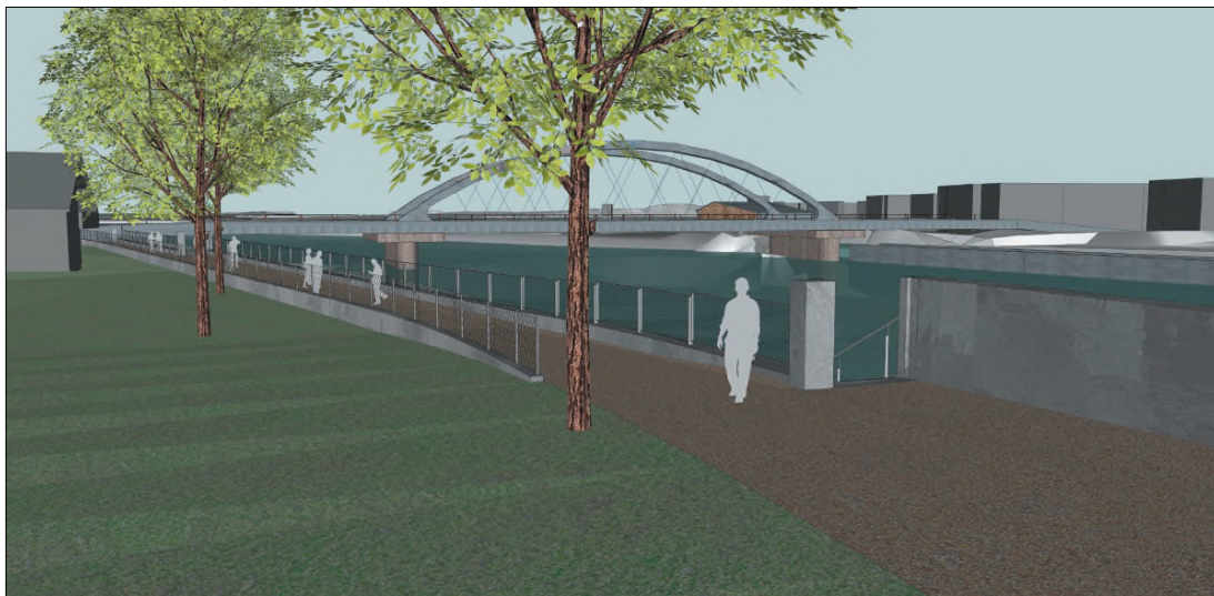
Abbildung 6: HWS-Mauer Variante 2 – Tiefliegender Uferweg mit Dammbalkensystem (offen, Ansicht von Osten).
