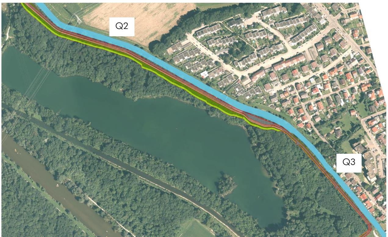
Abbildung 3 Übersichtsdarstellung des Vorhabens – Mittelteil (Originalmaßstab 1:2.000) – Homogener Deich mit Hinterweg (Q2) und homogener Deich mit Kronenweg (Q3)
