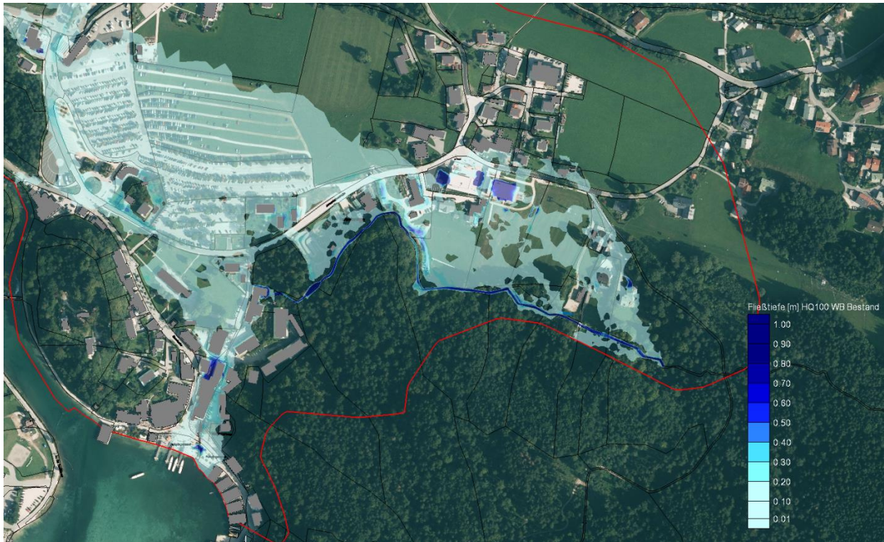
Abbildung 8: Gefährdungslage durch fluviatile Prozesse aus dem Pletzgraben bei HQ100 WB - Fließtiefen [m] (Quelle: aquasoli 2019)
