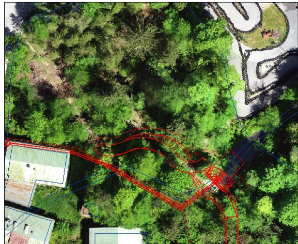
Abbildung 22: Lageplan Planung Einlaufbauwerk, Pletzgrabenverrohrung zu Zufahrt
