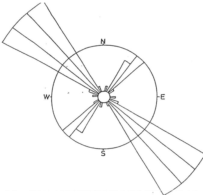
Abb. 1: Spalten, Klüfte und Kleinstörungen in der Massenfazies auf der obersten Abbausohle im Steinbruch Deisenstein. Der Kreis entspricht einer Häufung der Meßwerte von 10%.
