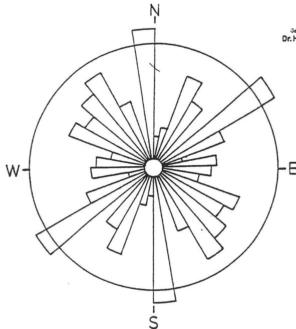
Abb. 3: Richtungsrose der Photolineationen. Der Kreis entspricht einer Häufung der Meßwerte von 10%.
