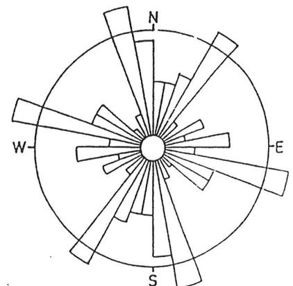
Abb. 2: Klüftmessungen in der Schichtfazies im tieferen Bereich des Steinbruchs Deisenstein. Der Kreis entspricht einer Häufung der Meßwerte von 10%.
