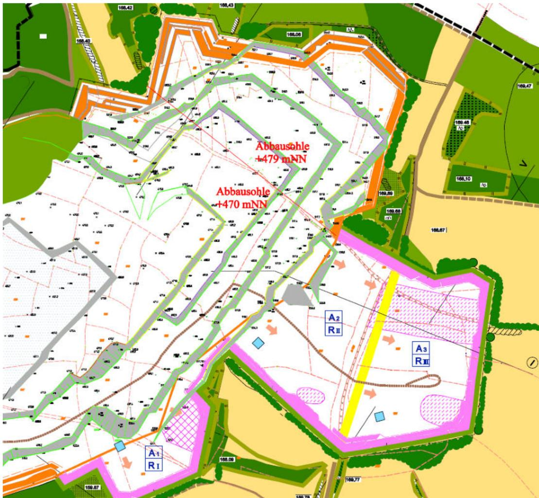
Abb. 4: Abbauplan vom 05.07.2005 des Planungsbüros Steinert (83236 Übersee) zur Ost-erweiterung mit Eintragungen/Ergänzungen der GBH GmbH von Juni 2009 zur Abbau - Niveaugrenze (s. rote Linie, rote Texte) gemäß dem Gutachten von SCHULER (Stand 09/2008, Anlage 1; Darstellung o. M., genordet; Quelle: Vorhabenträger)
