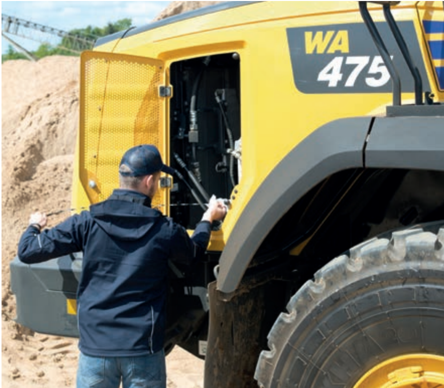
Sinnvoll positionierte Wartungsklappen ermöglichen einen bequemen und sicheren Zugang zu den täglich zu wartenden Punkten
