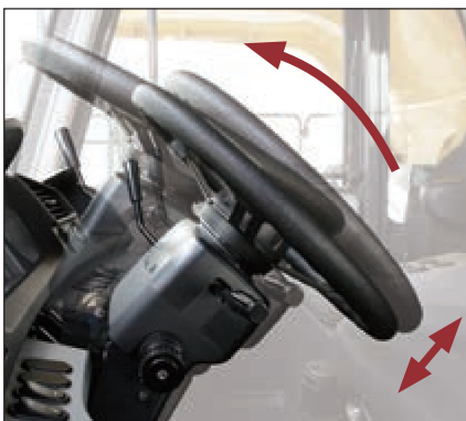
Das Lenkrad lässt sich für jeden Fahrer in die optimale Position bringen
