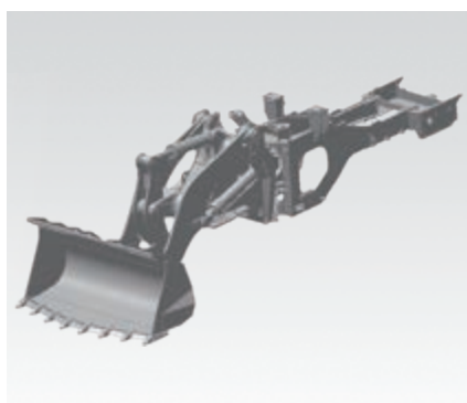
Robuster, verwindungssteifer Rahmen
