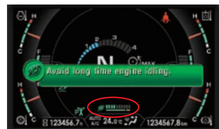
Eco-Anzeige und Eco-Hinweise mit aktiven Empfehlungen für noch kraftstoffeffizienteren Betrieb.
