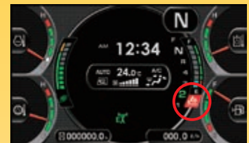
AdBlue®-Füllstandanzeige und Nachfüllhinweis
