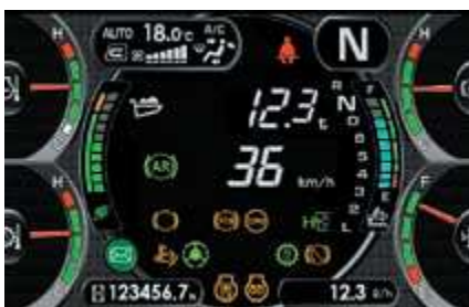
Auf einen Blick: Standardanzeige des Monitorsystems
