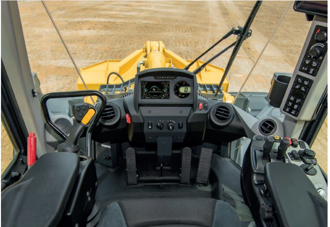
Bild zeigt Advanced Joystick-Lenksystem (AJSS) (Option)
