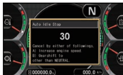
Die anpassbare, automatische Leerlaufabschaltung schaltet den Motor nach einer einstellbaren Zeitspanne im Leerlauf automatisch ab
