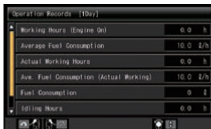
Ein Multifunktionsmonitorsystem ermöglicht die Anzeige und Einstellung von zahlreichen Betriebs- und Wartungsdaten.
