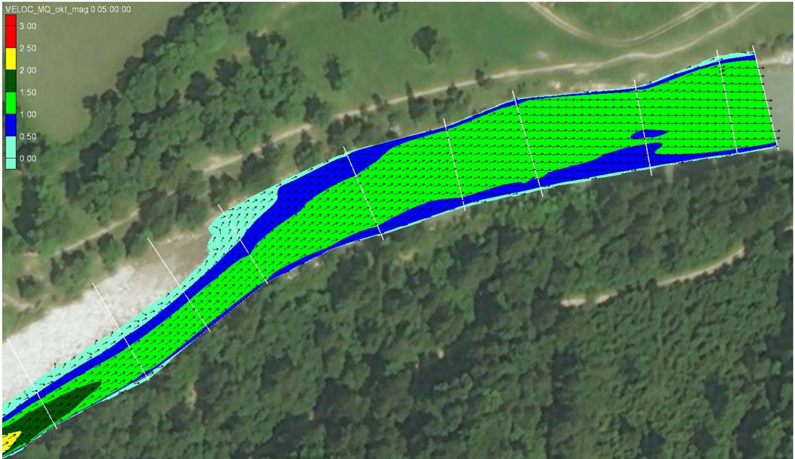
Fließgeschwindigkeiten inkl. Fließvektoren MQ – Abschnitt 1
