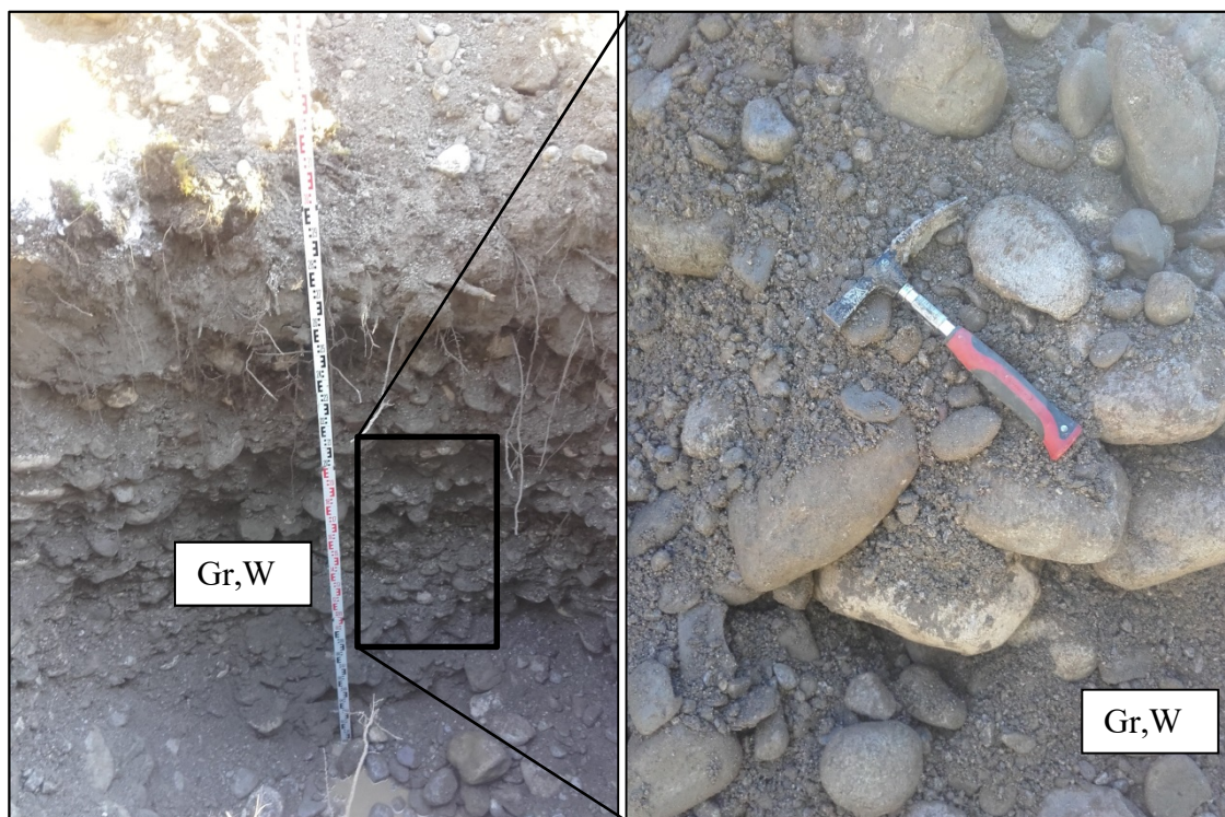
Abbildung 20: Baggereschurf BS01/17 - links : Geöffneter Baggereschurf bis 3,1m, GW bei 3,0m; rechts : Aushubmaterial gerundetes Kies-Sand-Stein Gemisch
