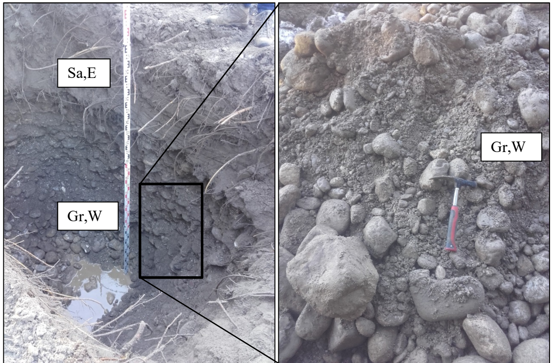
Abbildung 21: Baggereschurf BS02/17 - links : Geöffneter Baggereschurf bis 3,0m, GW bei 2,9m; rechts : Aushubmaterial gerundetes Kies-Sand-Stein Gemisch (Gr,W)
