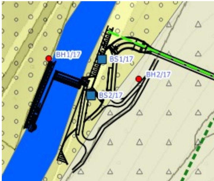
Abbildung 18: Lageplan der Wasserfassung und Einlaufbauwerk (nicht massstäblich)
