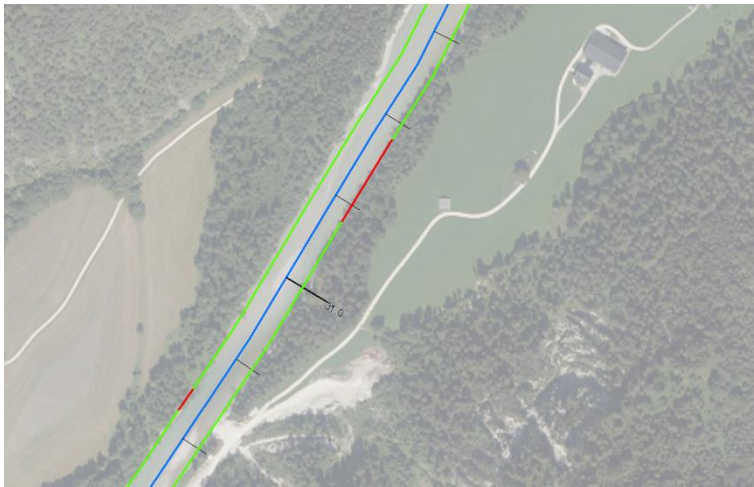
Abb. 10.6: Strukturierungsabschnitt südwestlich des Gehöfts Schwaiger. Die roten Linien kennzeichnen vorhandene Ufersicherungen (Ort-foto: Bayerische Vermessungs-verwaltung – www.geodaten.bayern.de , Kilometrierung: Berichtsgewässernetz Salzburg)
