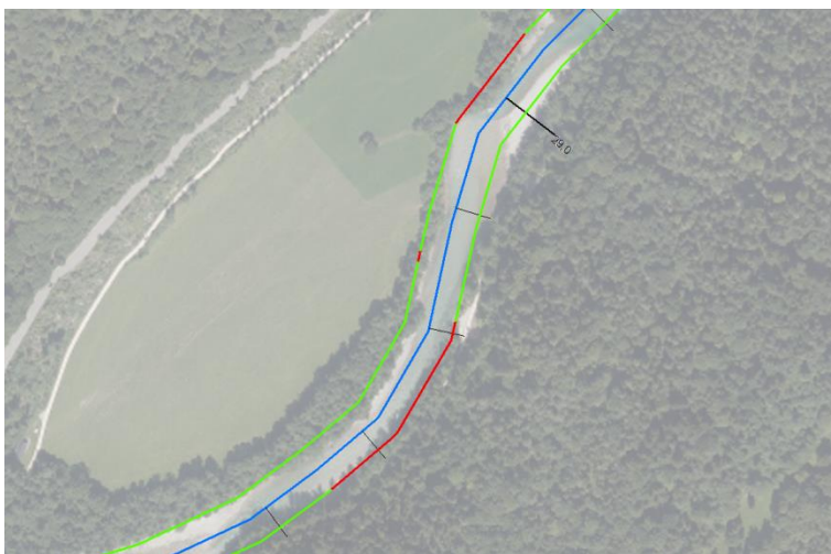
Abb. 10.11: Strukturierungsabschnitt oberhalb Schneizlreuth. Die roten Linien kennzeichnen vorhandene Ufersicherungen (Orthofoto: Bayerische Vermessungsverwaltung – www.geodaten.bayern.de , Kilometrierung: Berichtsgewässernetz Salzburg).
