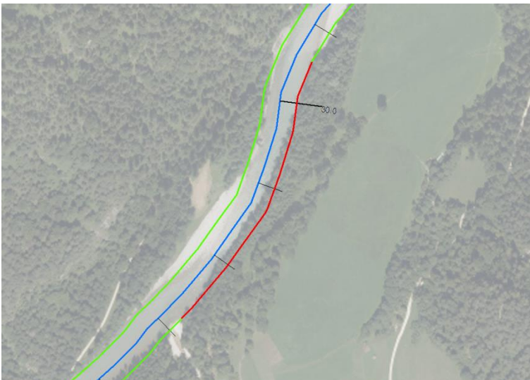
Abb. 10.9: Strukturierungsabschnitt unterhalb des Aschauerbachs. Die roten Linien kennzeichnen vorhandene Ufersicherungen (Orthofoto: Bayerische Vermessungsverwaltung – www.geodaten.bayern.de , Kilometrierung: Berichtsgewässernetz Salzburg).
