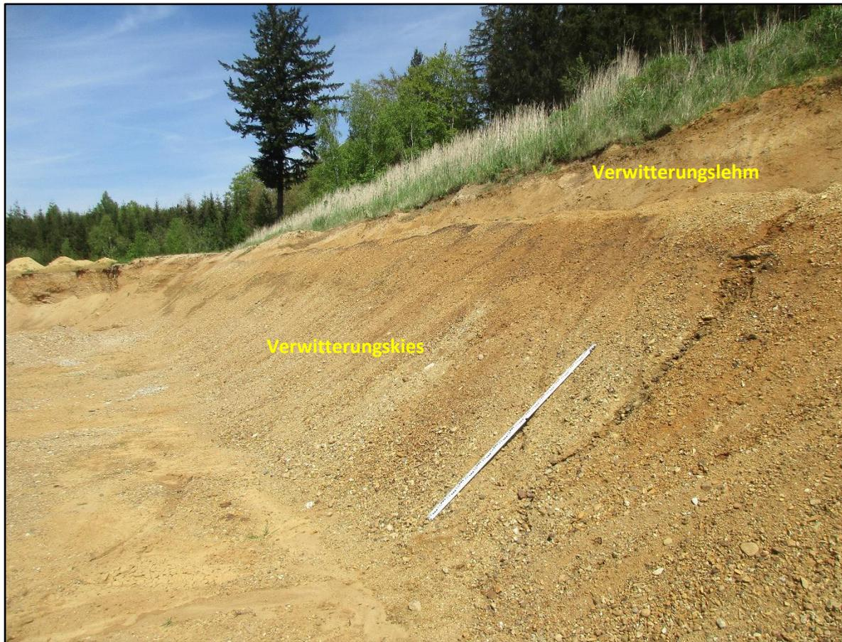
Abb. 3; Blick Richtung Nord-Ost auf den oberen Teil der östlichen Böschung mit Verwitterungslehm und Verwitterungskies (Stand 04.05.2023)
