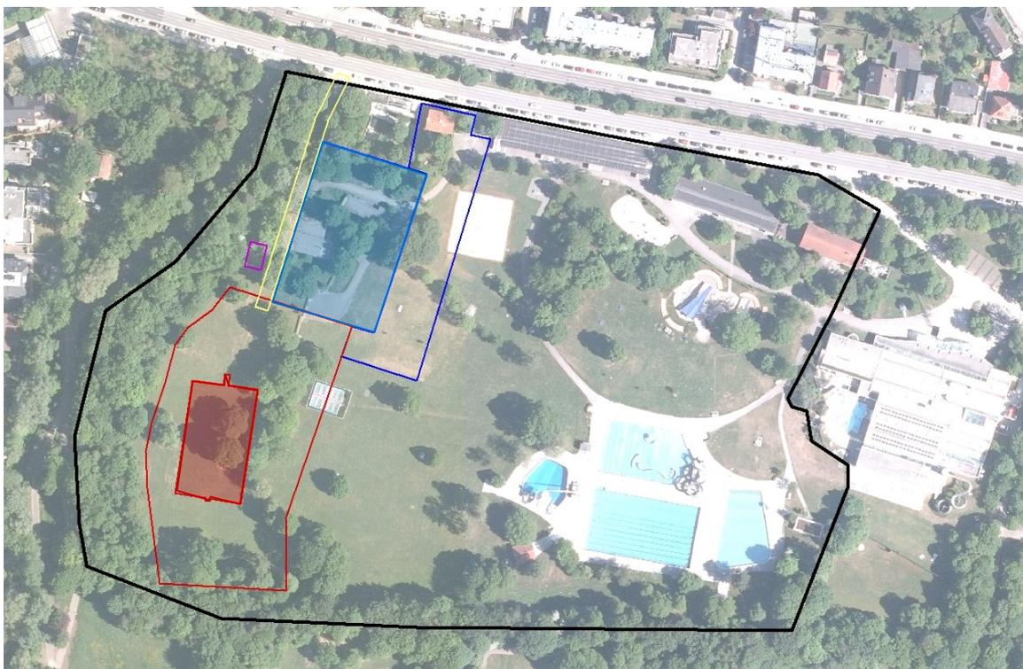
**Abb. 1:** Untersuchungsgebiet (schwarz), geplanter Bohrplatz (rot), Wärmestation (blau), Zufahrt (gelb), Container (lila)
