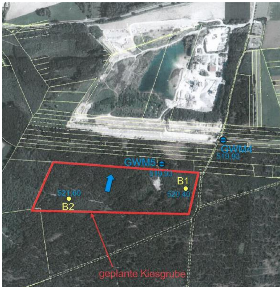
Abb. 5: Position der Bohrpunkte für Aufschlussbohrung (gelbe Punkte) und der Grundwassermessstellen (blaue Kreise) mit Grundwasserfließrichtung (blauer Pfeil); vgl. Hydrogeologische Standortbeurteilung (Köppe, 11.10.2018)
