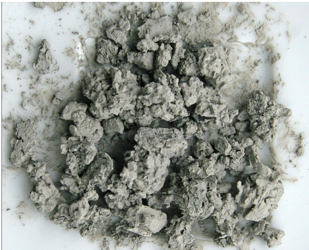
Abb. 11 B-K2/1, Bm 34-38: zur Bohrlochsohle zunehmend tonige Fazies, vermutlich Übergang Werfen Formation zu Haselgebirge
