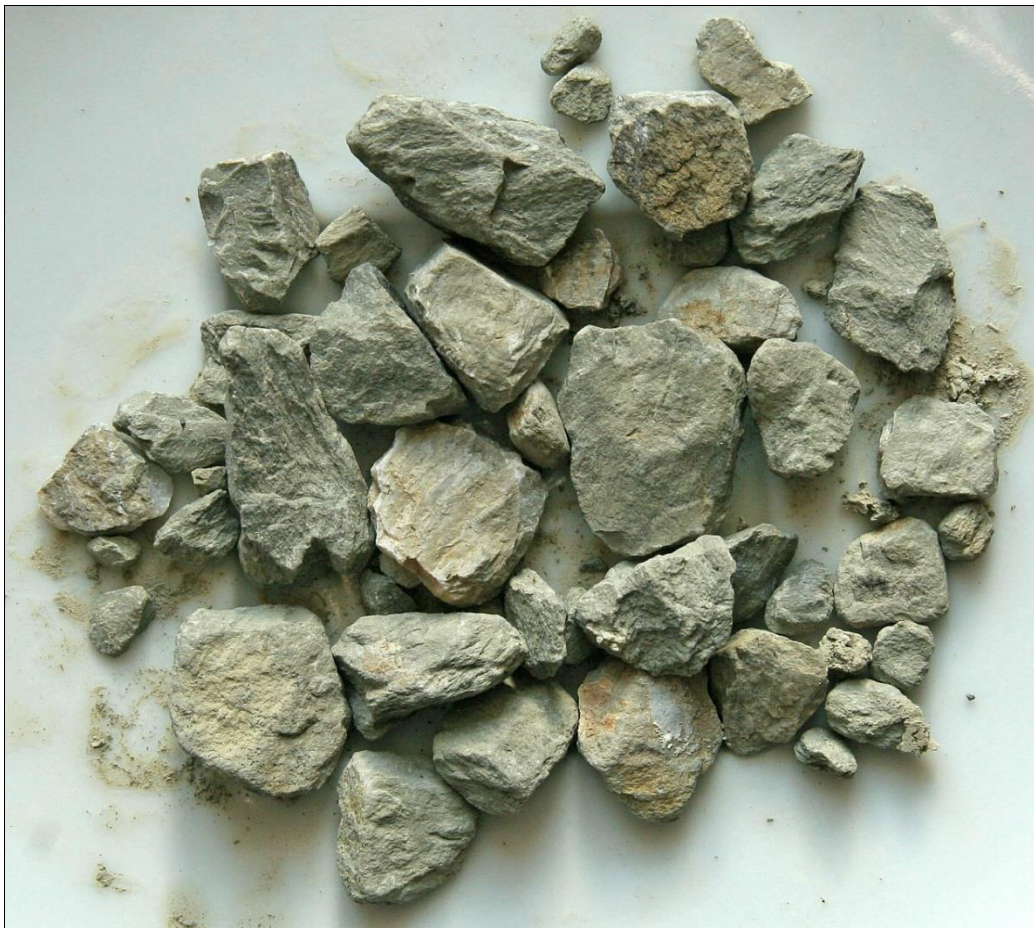
Abb. 10 B-K2/1, Bm 28-30: braungrauer Kalkmergel, vermutlich Werfen Formation
