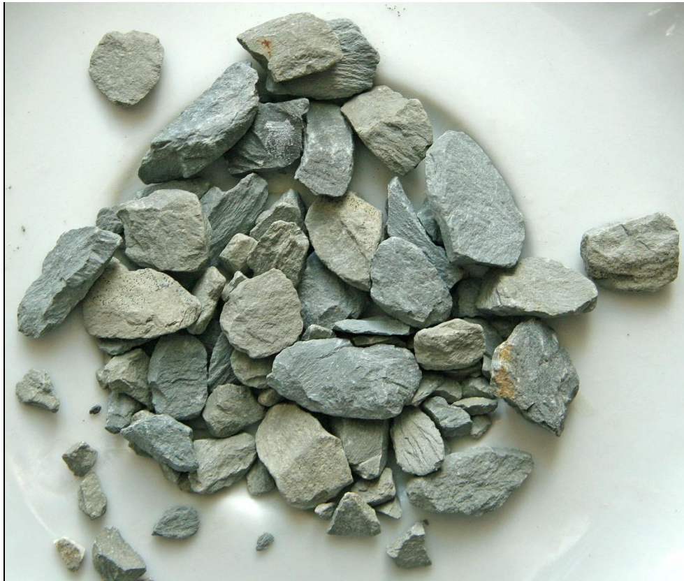
Abb. 12 B-K2/2, Bm 44-46: grünlichgrauer Kalkmergel, vermutlich Werfen Formation
