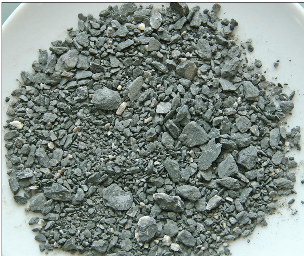
Abb. 13 B-K2/4, Bm 40-44: grünlichgrauer Kalkmergel, untergeordnet Sandstein, vermutl. Werfen Fm.
