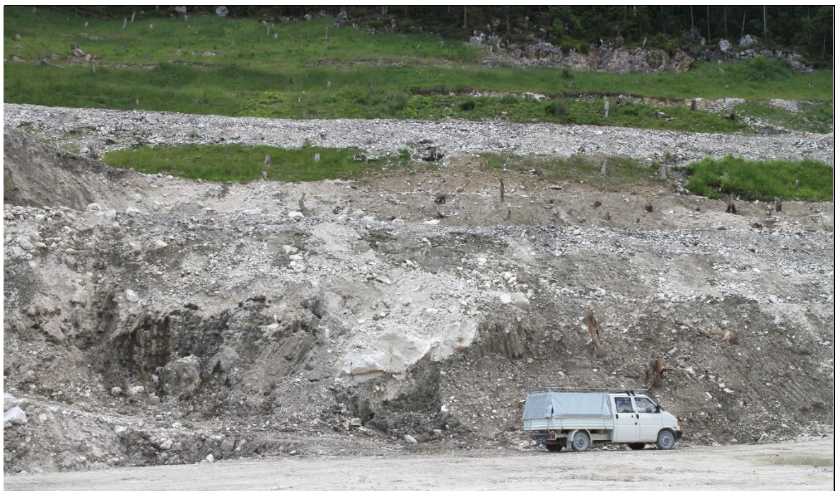
Abb. 8 Oben: ET 620, dunkelgrauer-roter Haselgebirgston mit eingelagerten weißen Gipskomponenten u. Holz. 31.10.2013
