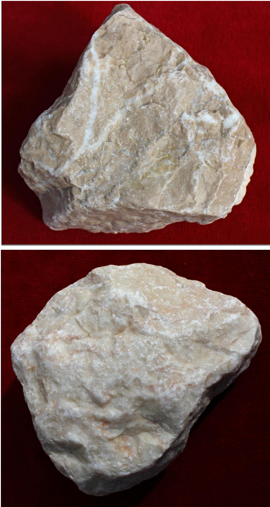
Abb. 15 Mikritischer Kalk, weiße Sparitklüfte, rote Hämatitbestege
