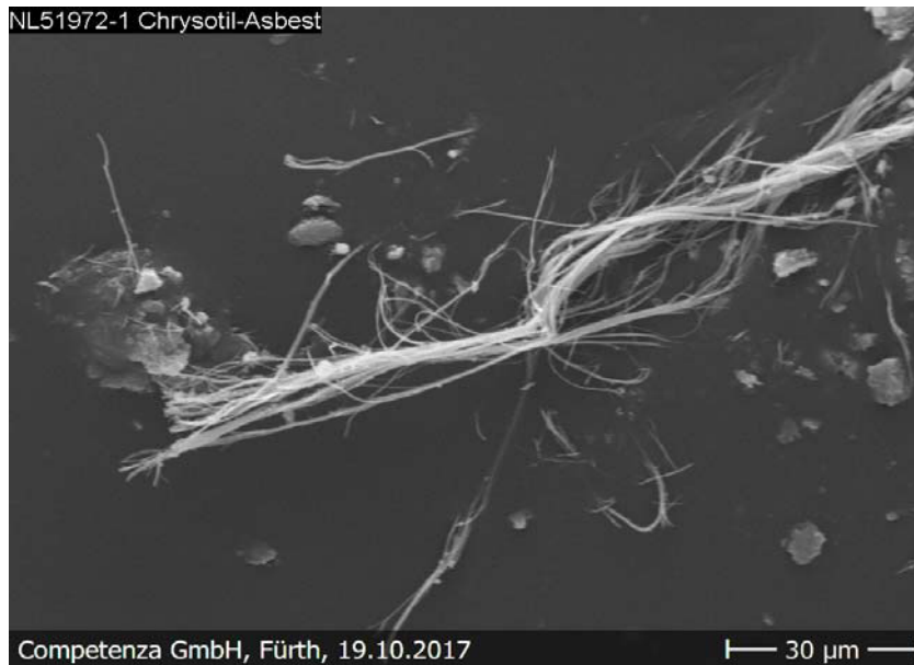
Abbildung und Elementspektrum: Chrysotil-Asbest Fundstelle NL51972.1
