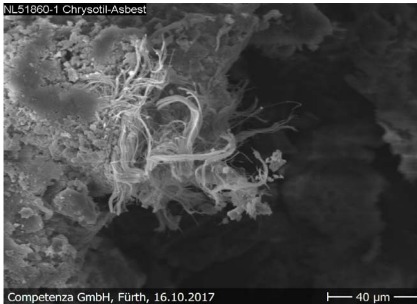
Abbildung und Elementspektrum: Chrysotil-Asbest Fundstelle NL51860.1
