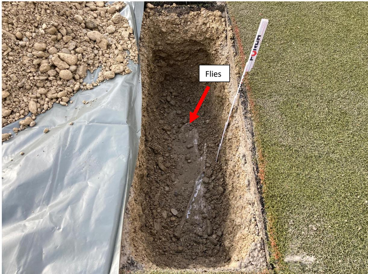
Abb. 2: Erkundungsschurf Abdeckung Altlast
