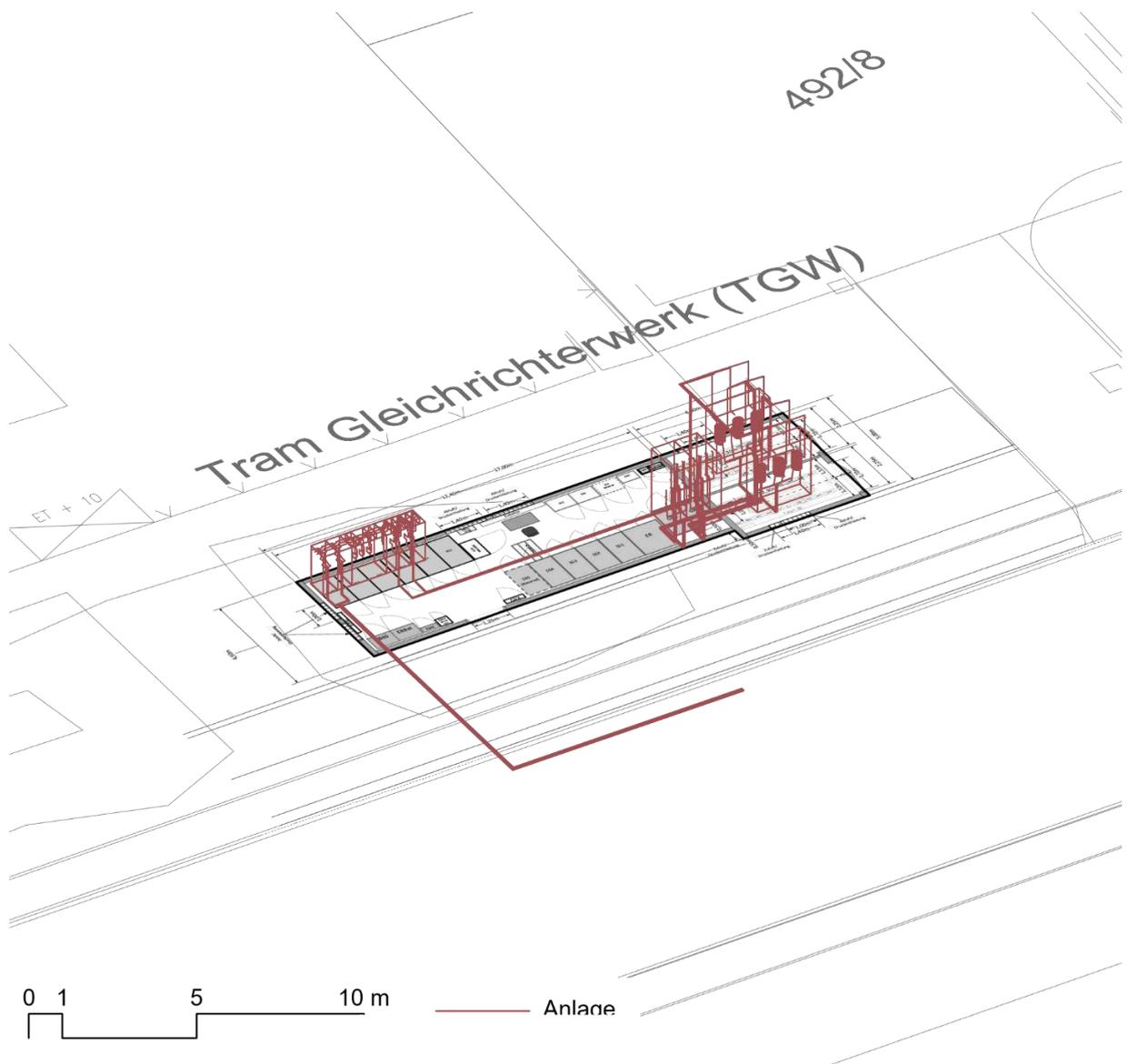
Abbildung 1. Räumliche Darstellung der modellierten elektrischen Betriebsmittel über dem Grundriss des Gebäudes.
