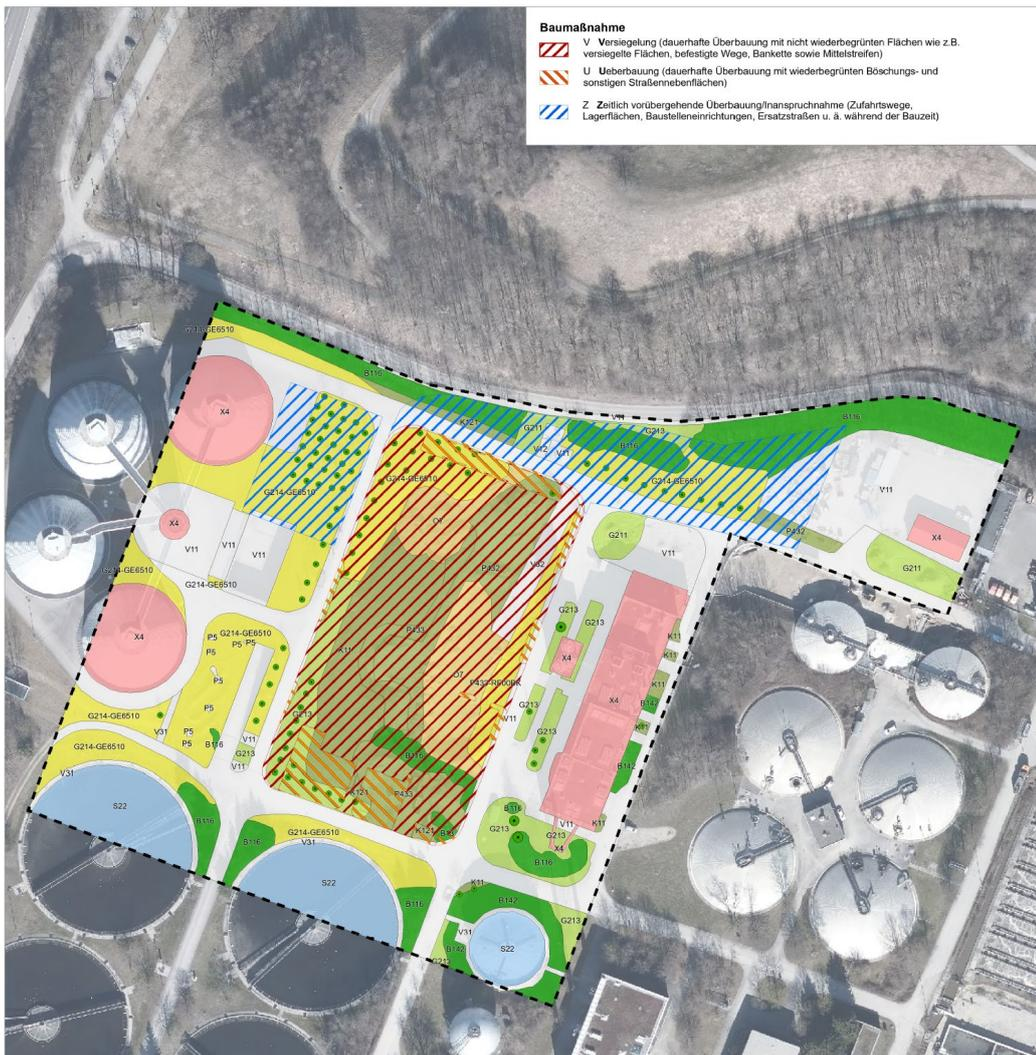
Abbildung 3.11 Beanspruchte Flächen in Bau und Betrieb [NRT 2022b]
