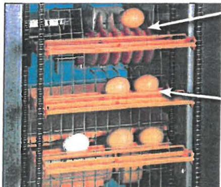
Patentiertes 2-Komponenten-Dosierrad mit einem Kern aus hartem Kunststoff und einer außen umlaufenden weichen und flexiblen Lippe → Vermeidung von Haarrisseiern
