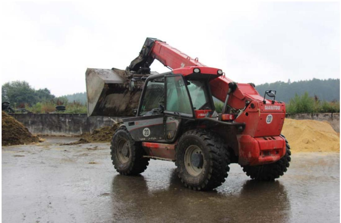
Foto 16: Blick auf den am Standort vorhandenen Teleskoplader vom Typ „Manitou MLT 345-120“.
