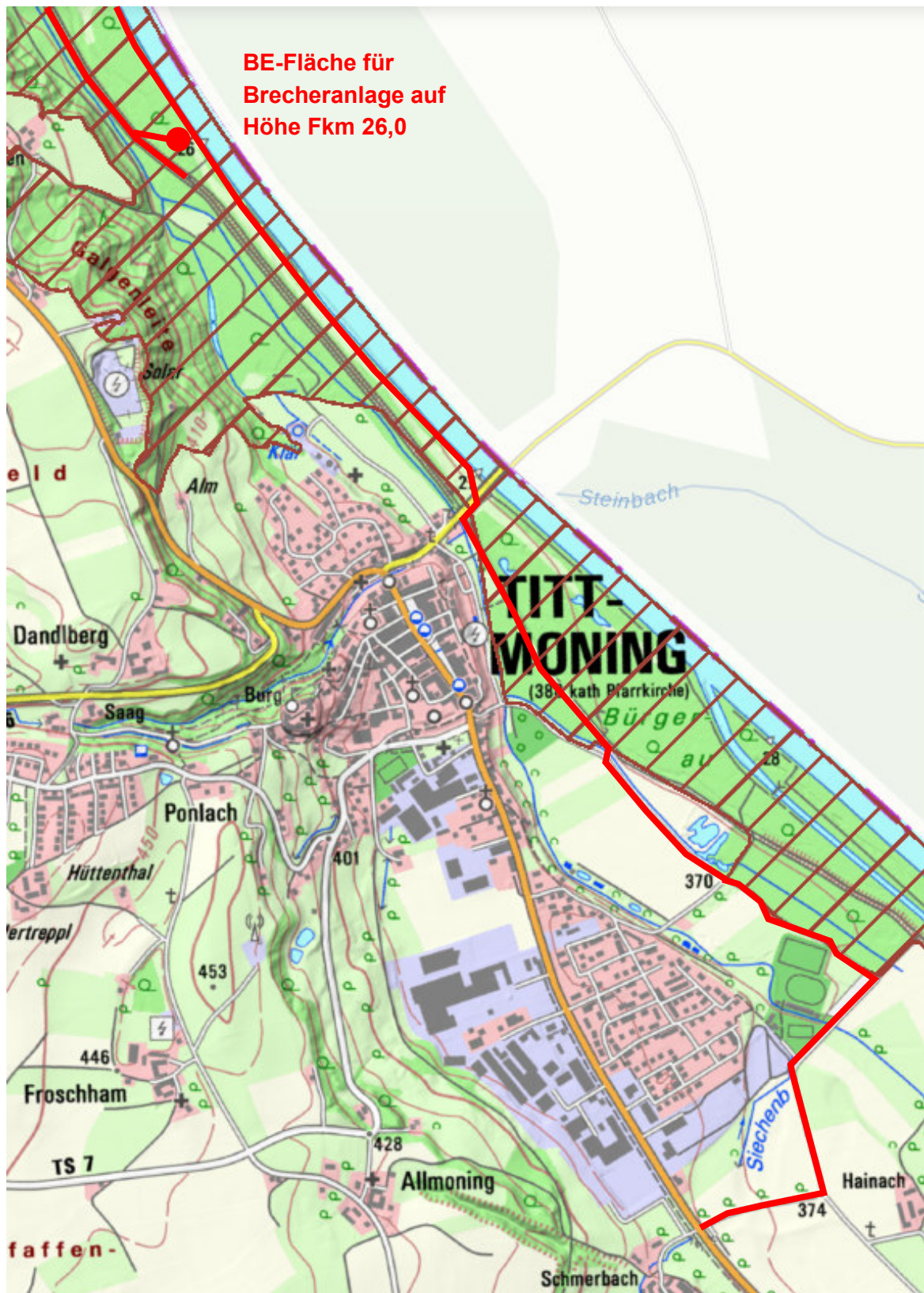
Abb. 9: Baustellenzufahrt und Standort für die mobile Brecheranlage
