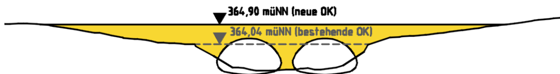
Abb. 11: schematische Darstellung zur Anhebung des Querungsbauwerks über den Siechenbach
