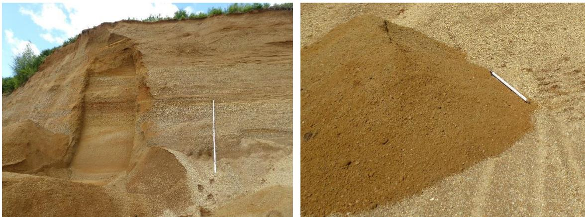
Bild links: Fertig gestellte Schlitzprobe 1. Die GOK liegt bei ca. 492 m NHN. Nach ca. 1 m Abraum folgen bis 11 m u. GOK das zu untersuchende Kies-Sand-Gemisch der mittelmiozänen Flussablagerungen der Geröllsandserie. Der beprobte Mächtigkeitbereich umfasst 3 bis 11 m unter GOK.
