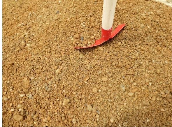
Bild links: Fertig gestellte Schlitzprobe 2. Die GOK liegt bei ca. 492 m NHN. Nach ca. 1 m Ab-raum folgen bis 13 m u. GOK das zu untersuchende Kies-Sand-Gemisch der mittelmiozänen Flussablagerungen der Geröllsandserie. Der beprobte Mächtigkeitbereich umfasst 6 bis 13 m unter GOK.
