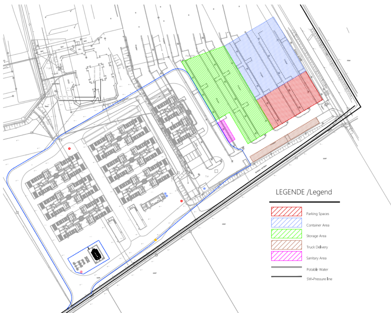
Abb. 1: Anordnung der geplanten Peakeranlage inkl. Baustelleneinrichtungsflächen, o.M.
