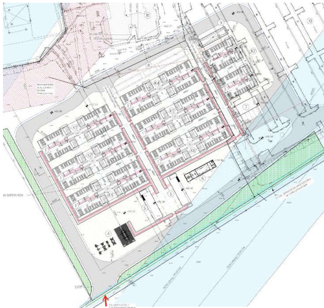
Abbildung 5. Übersicht der Einheiten und Motoren der Peakeranlage RWE Generation SE am Standort Gundremmingen, entnommen aus der Anlagen- und Betriebsbeschreibung [23].
