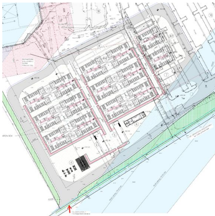
Abbildung 6: Lageplan 28 x 4 MW el Gasmotorenanlage
