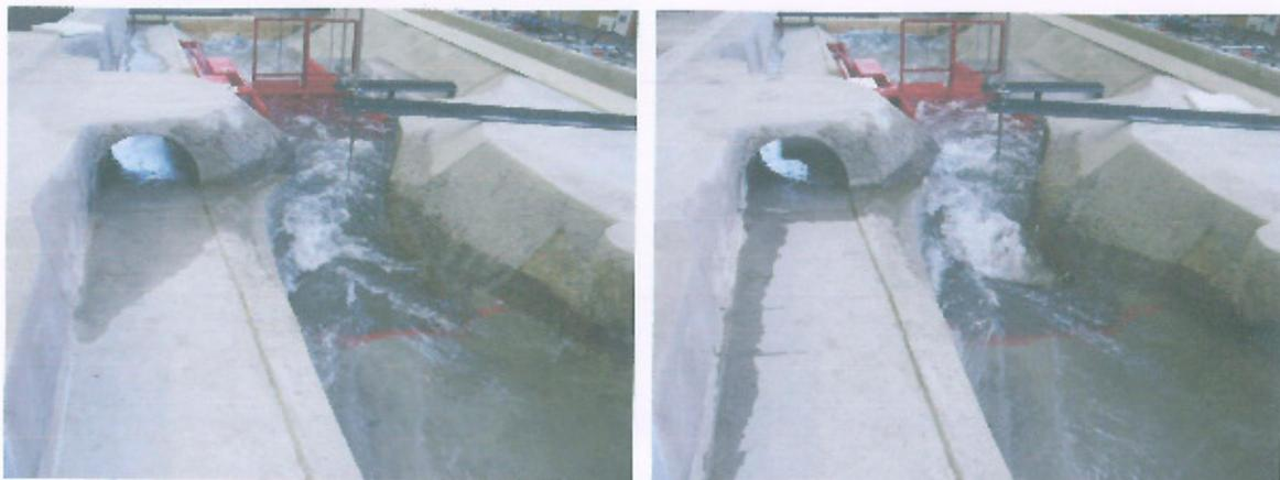
Abb. 5-9: Betriebssituation (BS) „Zs“ für  $HQ_{100}$  (links) und  $HQ_{1,000}$  (rechts), Blick jeweils in Fließrichtung
