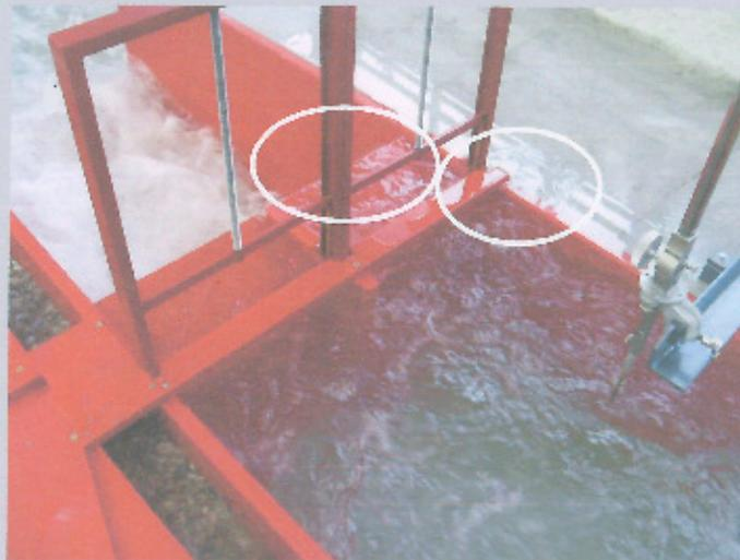
Abb. 5-11: Starke Pulsationen am Bauwerk mit Überströmungen (hier bei HQ<sub>100</sub>)
