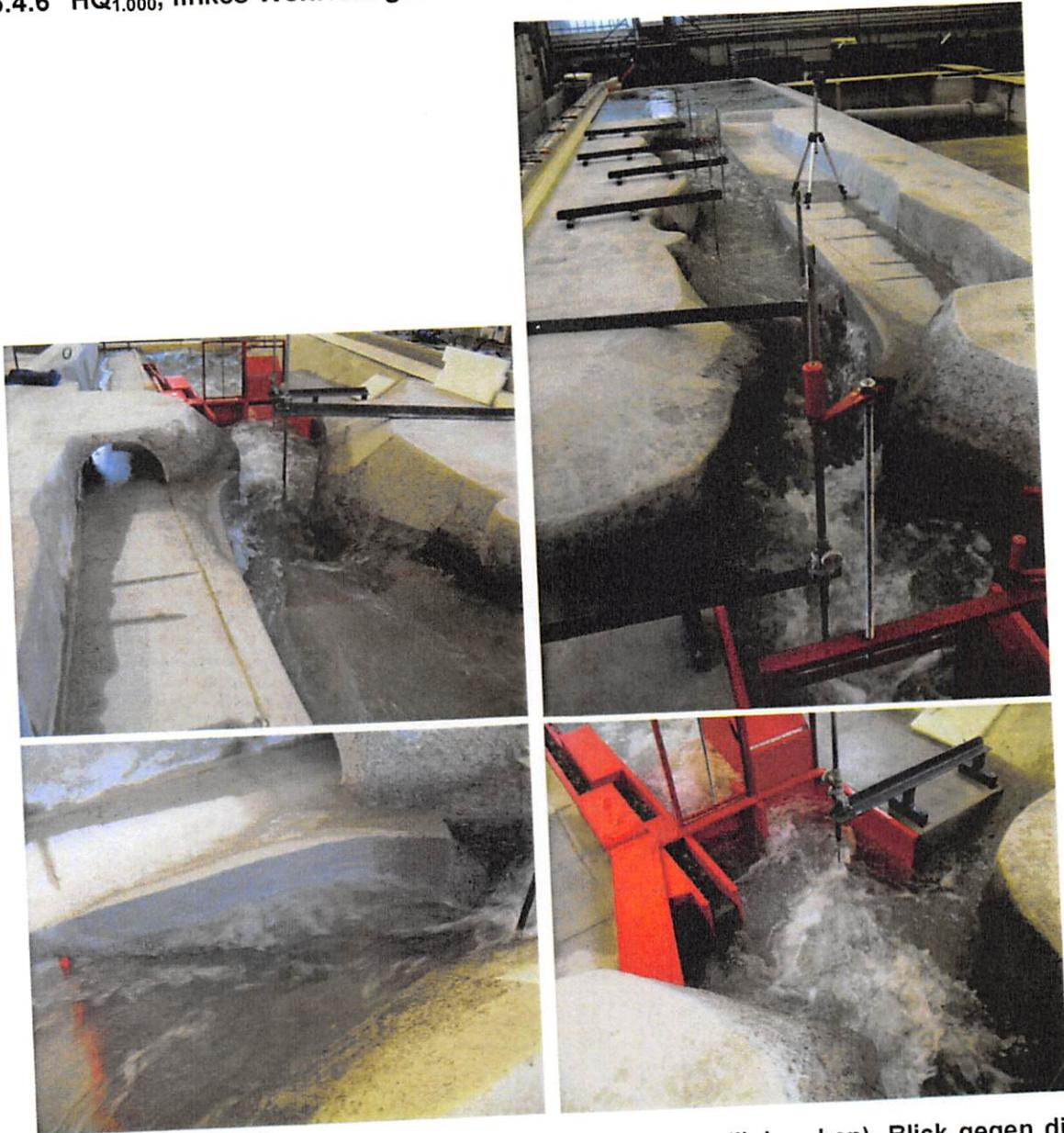
Abb. 5-17: HQ<sub>1.000</sub> bei (n-1, links): Blick in Fließrichtung (links oben), Blick gegen die Fließrichtung (rechts oben), Widerlager Steg (links unten), unmittelbarer Oberwasserbereich am Wehr (rechts unten)
