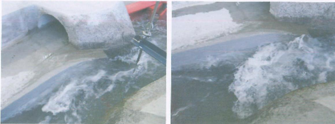
**Abb. 5-10: Widerlager des Stegs bei  $HQ_{100}$  (links) und  $HQ_{1.000}$  (rechts)**
