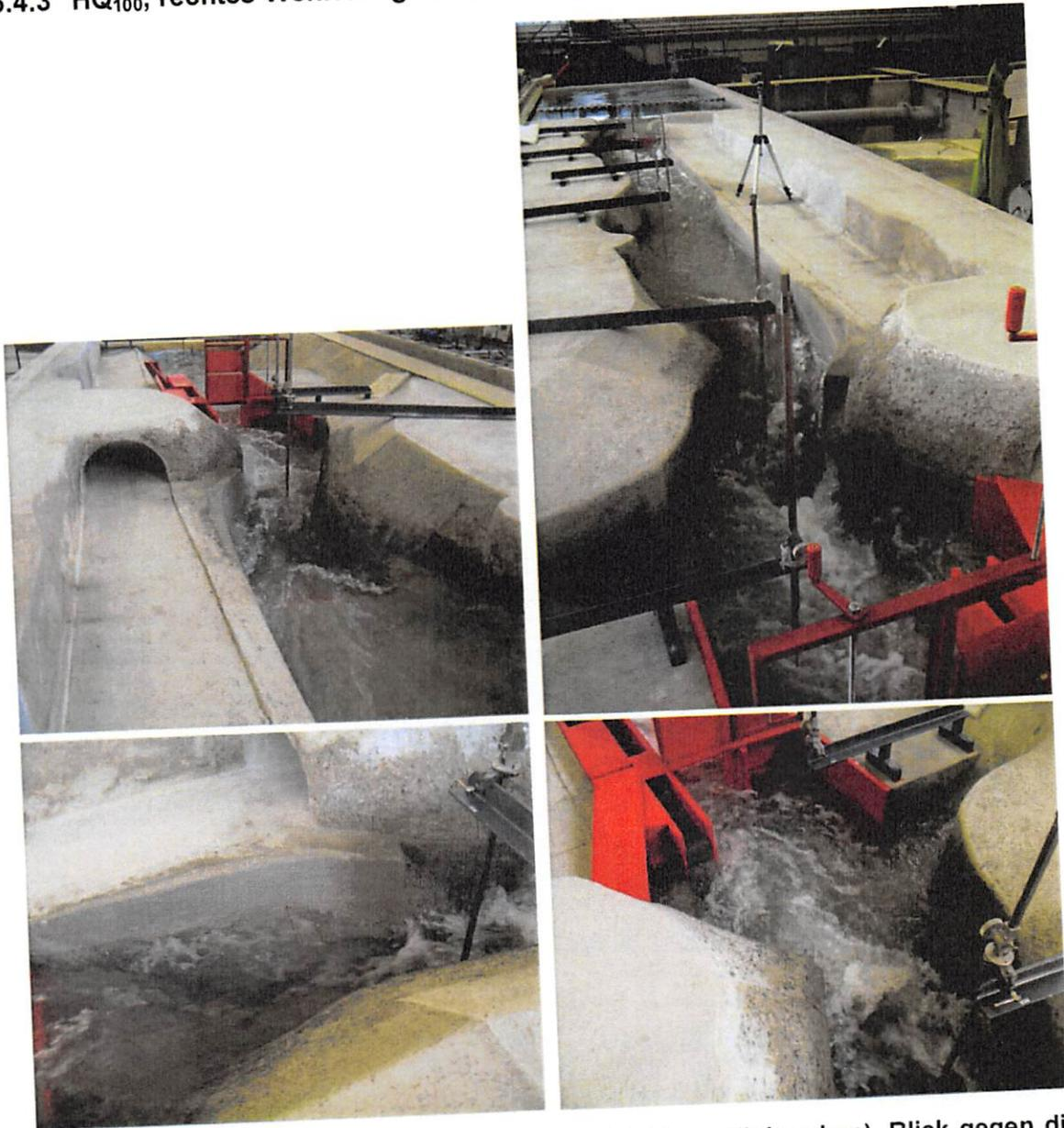
Abb. 5-14: HQ<sub>100</sub> bei (n-1, rechts): Blick in Fließrichtung (links oben), Blick gegen die Fließrichtung (rechts oben), Widerlager Steg (links unten), unmittelbarer Oberwasserbereich am Wehr (rechts unten)
