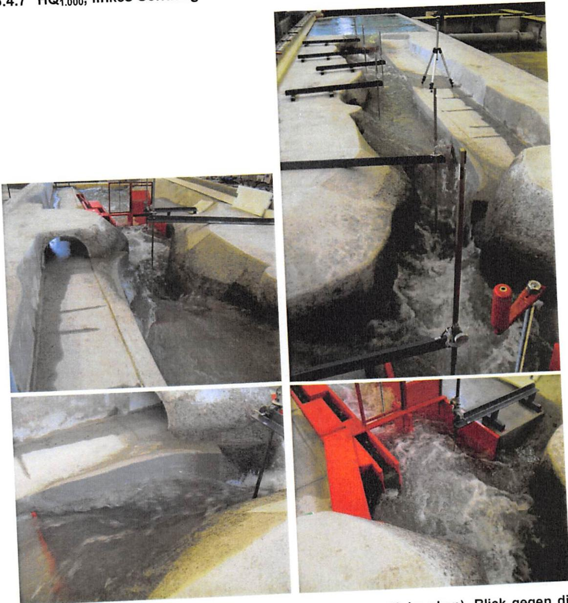
Abb. 5-18: HQ<sub>1.000</sub> bei (n-a, links): Blick in Fließrichtung (links oben), Blick gegen die Fließrichtung (rechts oben), Widerlager Steg (links unten), unmittelbarer Oberwasserbereich am Wehr (rechts unten)
