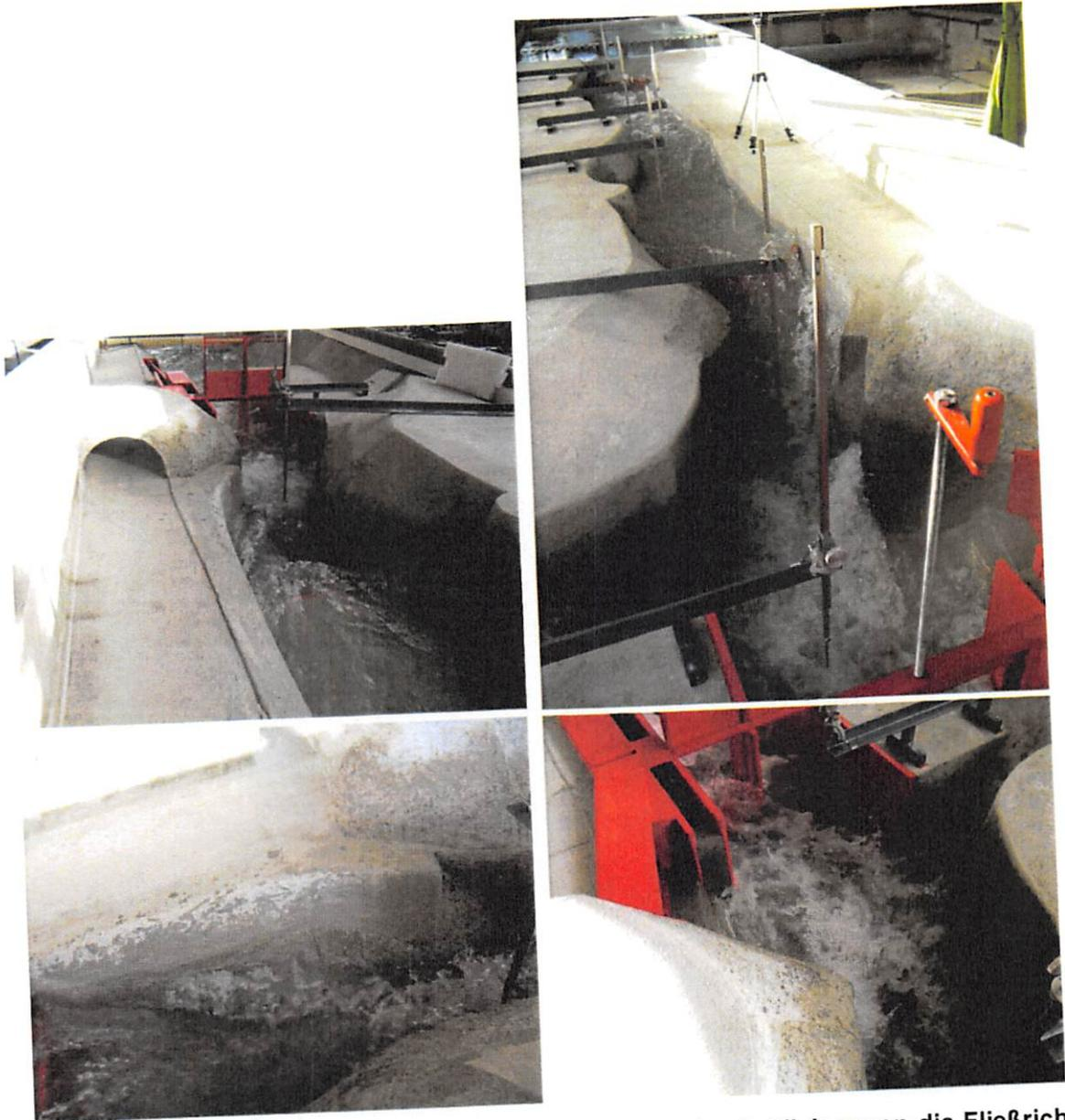
Abb. 5-16: HQ<sub>100</sub> bei (n): Blick in Fließrichtung (links oben), Blick gegen die Fließrichtung (rechts oben), Widerlager Steg (links unten), unmittelbarer Oberwasserbereich am Wehr (rechts unten)
