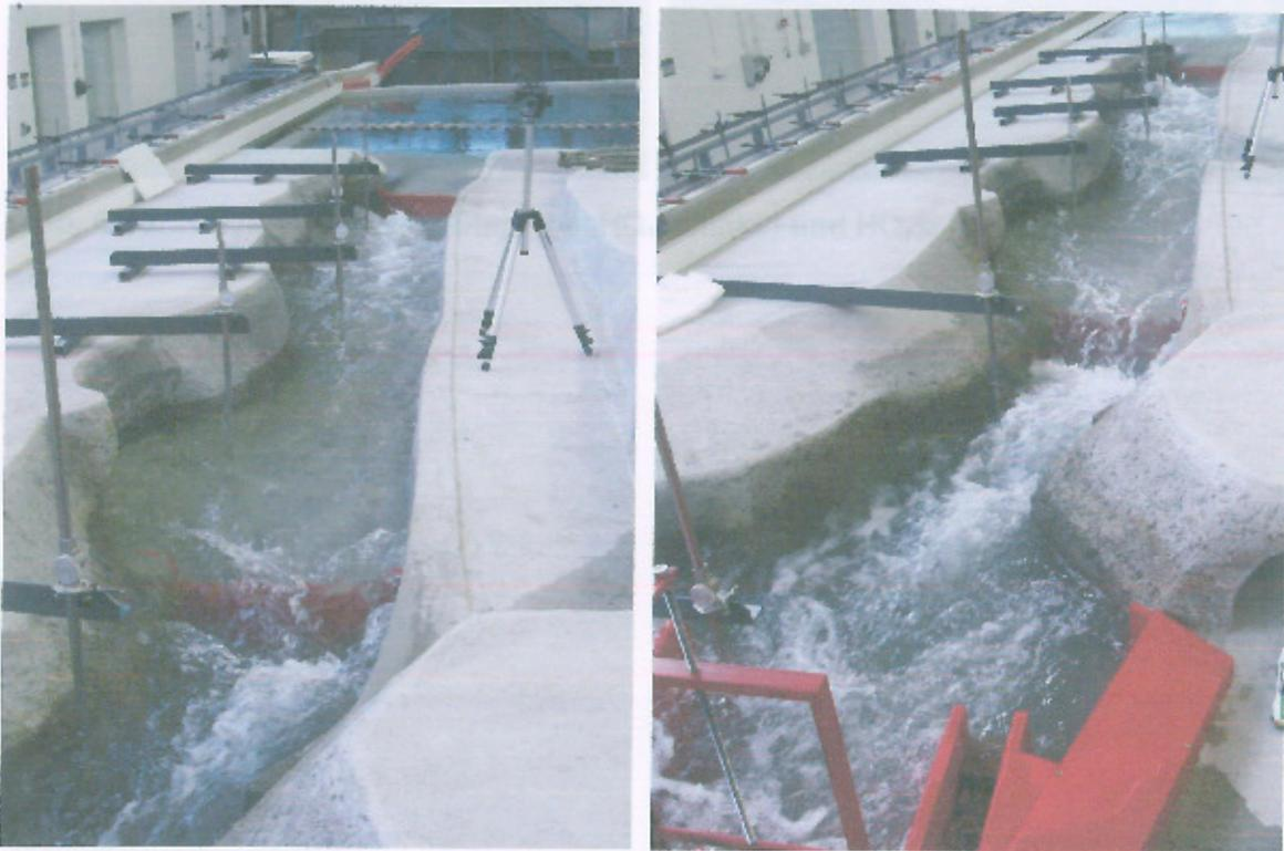
Abb. 5-8: Betriebssituation (BS) „Zs“ für  $HQ_{100}$  (links) und  $HQ_{1,000}$  (rechts), Blick jeweils gegen die Fließrichtung
