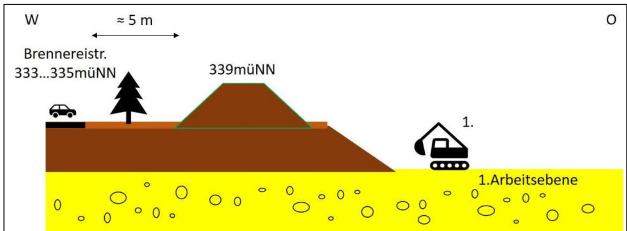
**Abbildung 1:** schematische Darstellung der beantragten Ausnahme, „Errichtung einer Verwallung entlang der Brennereistr.“
