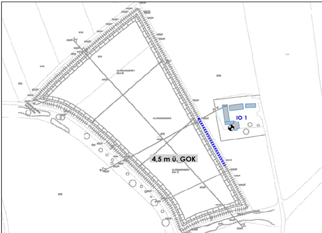
Abbildung 6: Darstellung des zu errichtenden Lärmschutzwalls mit Eintragung der Höhe über Gelände
