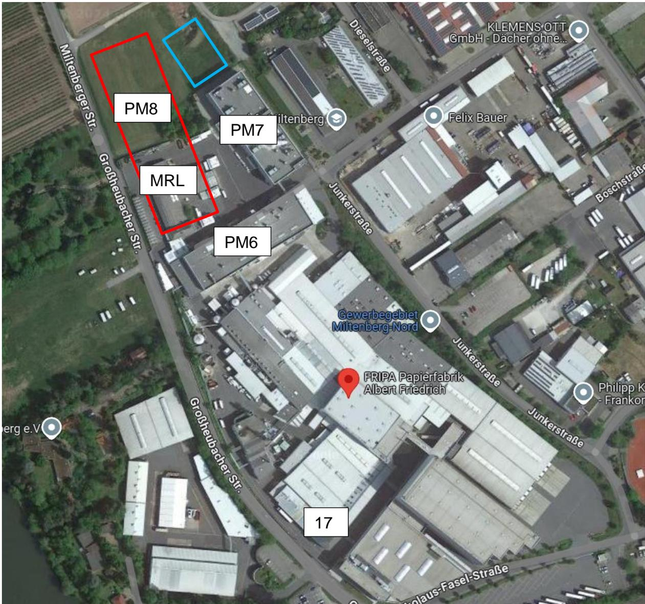
Abb.1: Luftbild mit Darstellung der neuen Papiermaschine 8 samt Mutterrollen-Lager (rot) und der Zellstoffüberdachung (blau)
