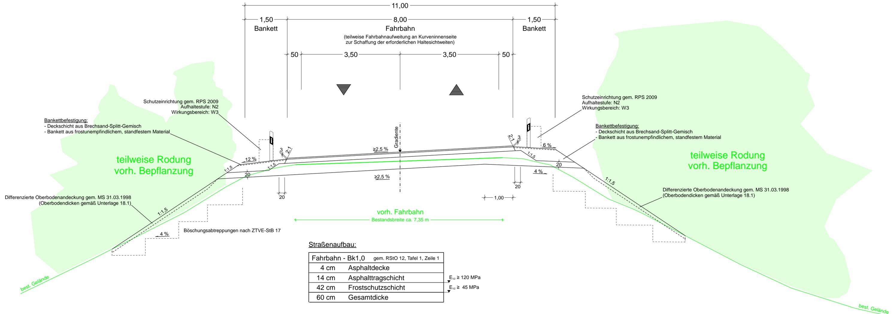
Ausbildung der Damm- und Einschnittsböschungen nach RAL 2012, Bild 4
