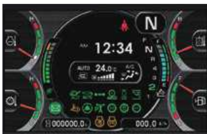
Auf einen Blick: Standardanzeige des Monitorsystems
