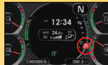
AdBlue®-Füllstandanzeige und Nachfüllhinweis
