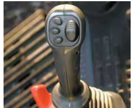
Joysticks mit Proportionalsteuerung für Anbaugeräte
