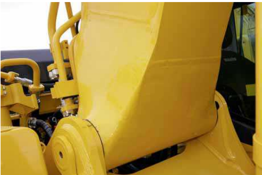
Auslegerfuß aus Stahlguss
