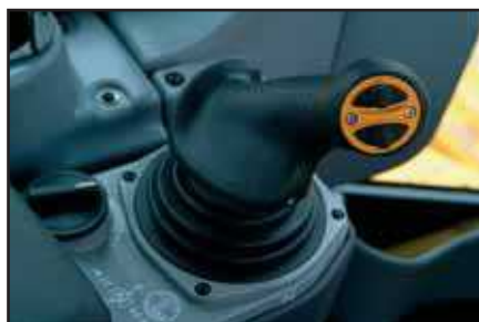
Linker Joystick für Fahrfunktionen
